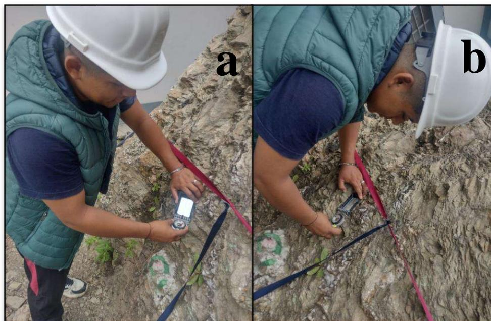
*Ilustración 47. Subzona 1-001, dirección(a) y buzamiento (b) de la discontinuidad*
