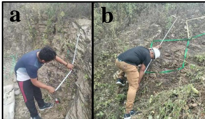
**Ilustración 60.** *Longitud de discontinuidad, SubZona 1-0010(a),5-0018(b)*
