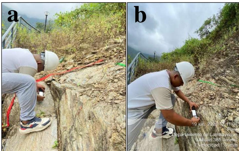
*Ilustración 51. SubZona 3-001, dirección(a) y buzamiento (b) de la discontinuidad*
