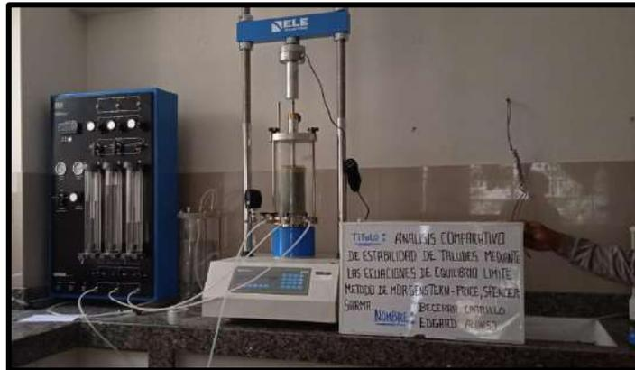
*Ilustración 42. Ensayo triaxial de las muestras.*
