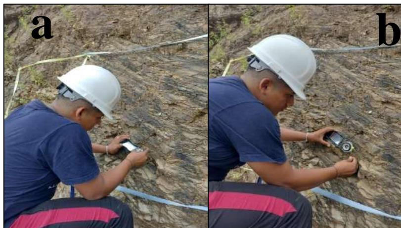
*Ilustración 53. SubZona 4-001, dirección(a) y buzamiento (b) de la discontinuidad*
