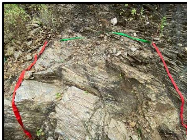
**Ilustración 65.** Meteorización del macizo rocoso de grado III, SubZona 3-001
