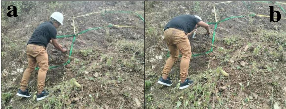
*Ilustración 55. SubZona 5-001, dirección(a) y buzamiento (b) de la discontinuidad.*
