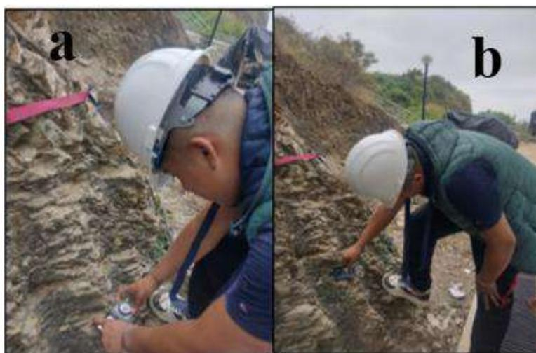
**Ilustración 49.** Subzona 2-001, dirección(a) y buzamiento (b) de la discontinuidad
