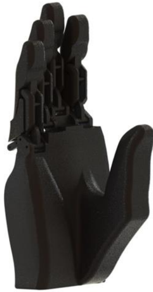
Figura 32: a) Vista isométrica de ensamble de mano.
