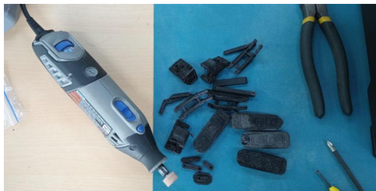
Figura 59: Lijado de piezas con herramienta Mototool
