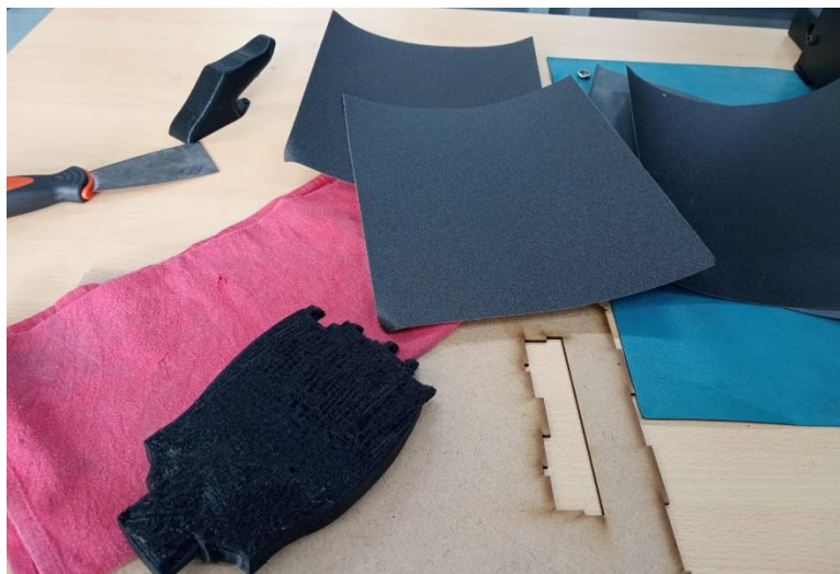
Figura 60: Lijado y pulido de piezas con lijas de distintos No de grano
