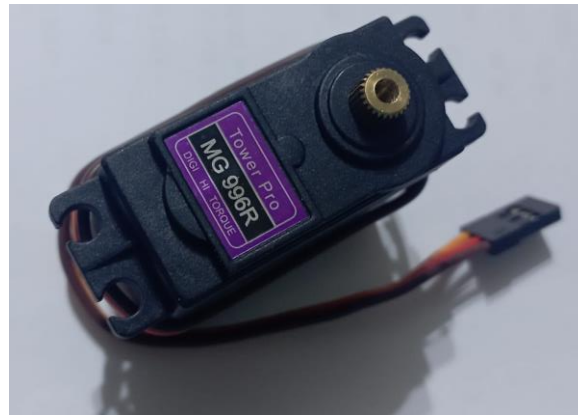
Figura 40: Servomotor Tower Pro MG996R. Fuente: Elaboración propia.
