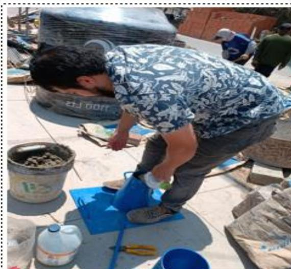
**Ensayo de Consistencia del concreto (slump)**
