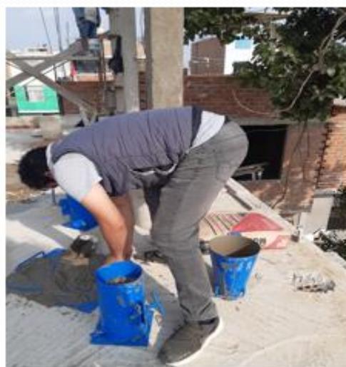
**Toma de muestra y Ensayo de Consistencia del concreto (slump)**
