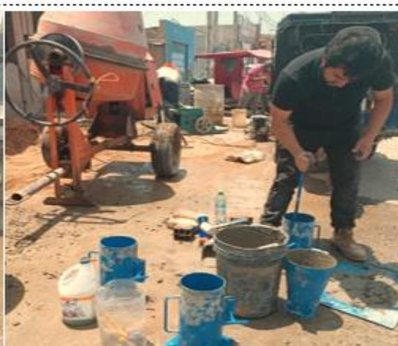
**Elaboración de probetas de concreto**
