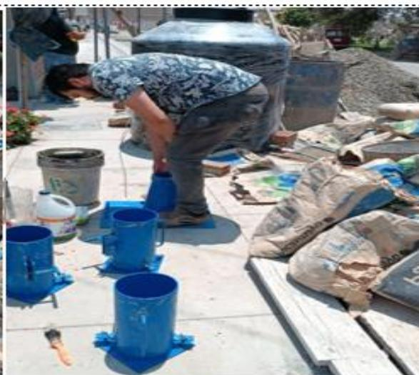
**Ensayo de Consistencia del concreto (slump)**
