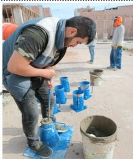
**Ensayo de Consistencia del concreto (slump)**
