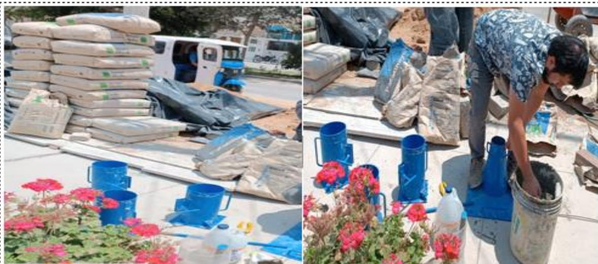
**Ensayo de Consistencia del concreto (slump)**
