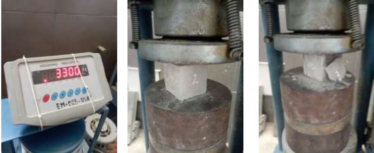
Figura 9: Rotura de mortero a los 14 días con ceniza delonix
