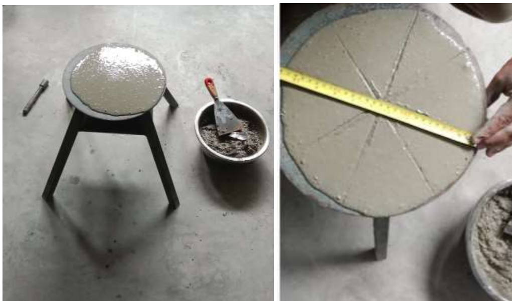
Figura 6: medición de fluidez de mortero)
