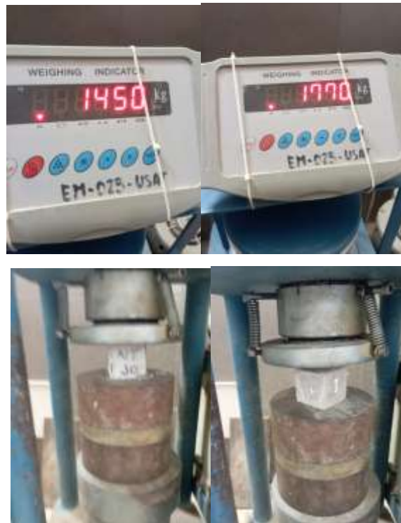
Figura 4: Rotura de mortero a los 7 días
