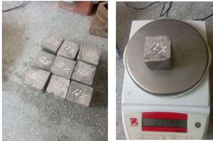
Figura 11: Peso húmedo en báscula de morteros con ceniza
