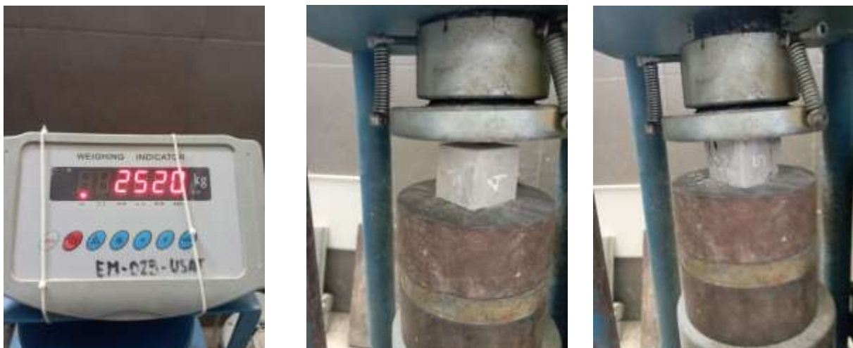
Figura 8: Rotura de mortero a los 7 días con ceniza delonix
