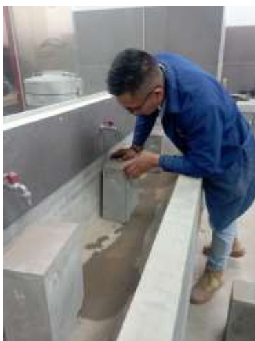
Figura 19: Muros con recubrimiento en estanque
