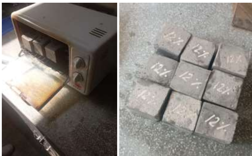
Figura 13: Secado muestras en horno
