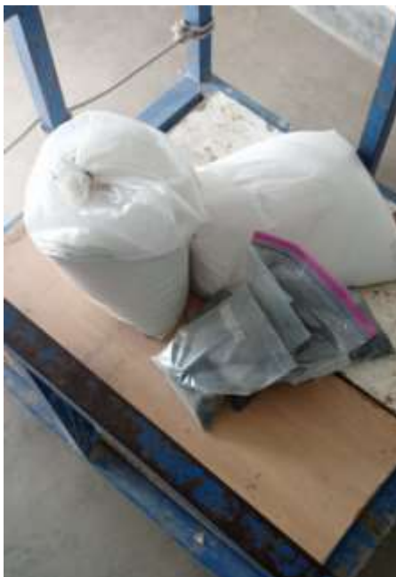
Figura 5: Dosificación de sulfato de calcio y ceniza para la fabricación de mortero
