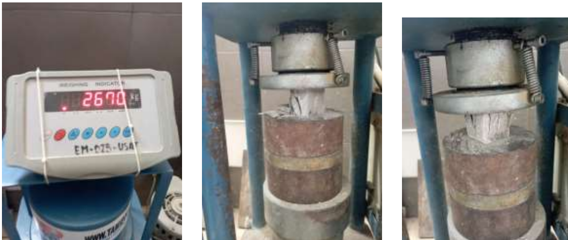
Figura 10: Rotura de mortero a los 28 días con ceniza delonix
