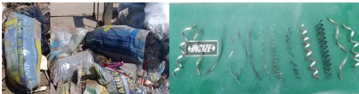
Fig. 27 Obtención y dimensiones de las virutas de acero reciclado
