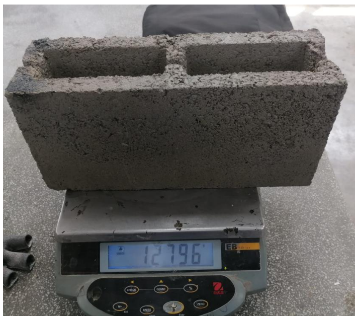
Fig.48 Toma de pesos, para el ensayo de Absorción de unidades de albañilería.
