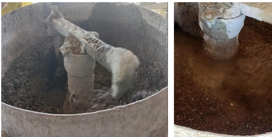
Fig. 36: Mezcladora de BATEA diámetros 1.30 x 0.60 m x 0.75 Marca Ba9, con los materiales para la elaboración de los bloques de concreto
