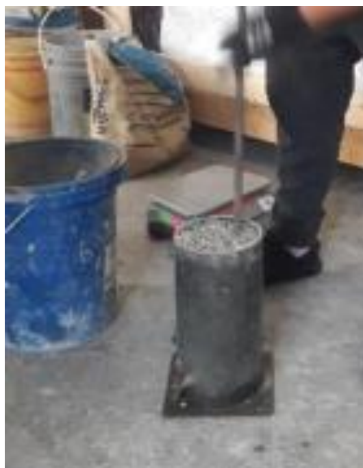
Fig. 32 Compactación por varillado por capas del Agregado Grueso
