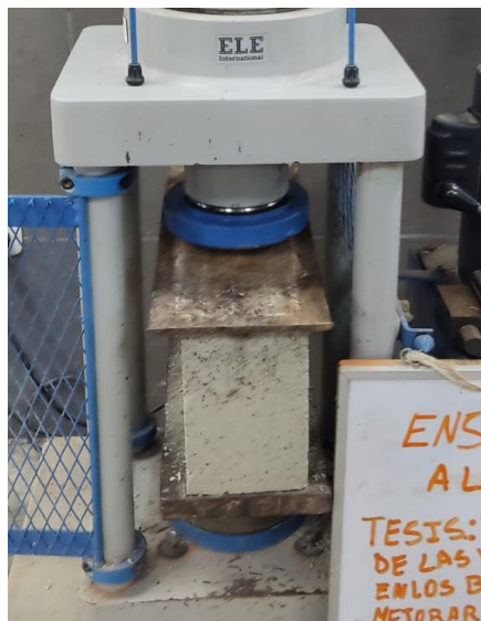
Fig. 51 Unidad de albañilería dentro del equipo de compresión axial.
