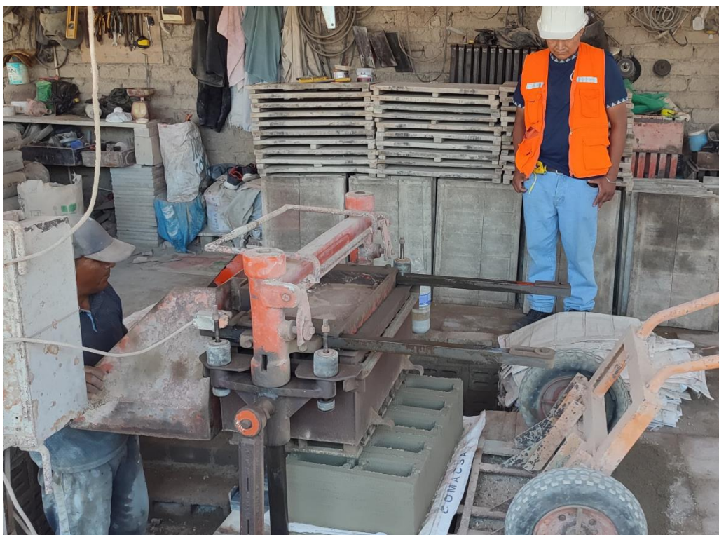
Fig. 42: Desmoldado de los bloques de concreto
