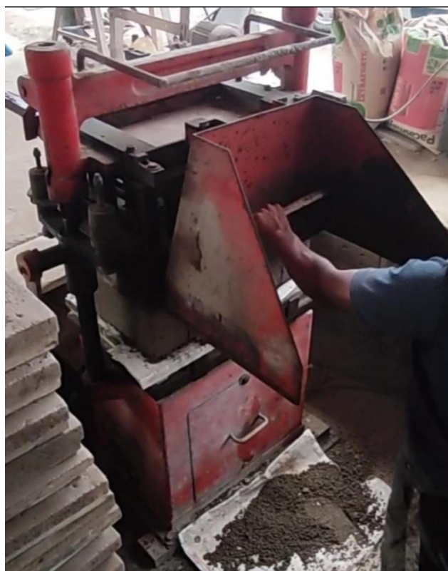
Fig. 41: Desmoldado de los bloques de concreto
