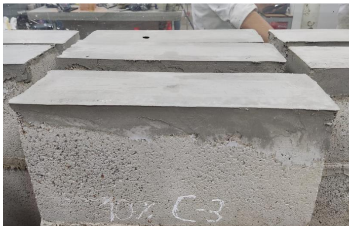
Fig. 22 Refrentado de las muestras para el ensayo de resistencia a la compresión
