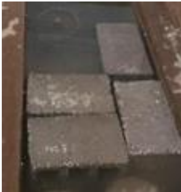
Fig. 47 Muestras sumergidas en agua, para el ensayo de Absorción de unidades de albañilería.
