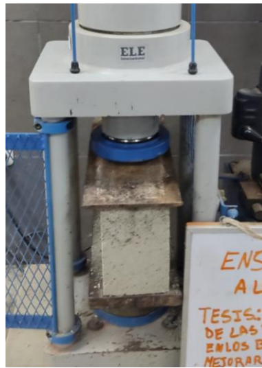
Fig. 13 Bloque de concreto sometido a compresión [6]
