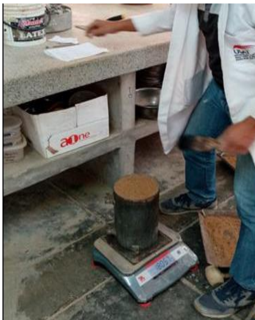
Fig. 30: Recolección de datos del ensayo de peso unitario del agregado.
