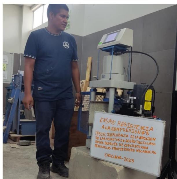
Fig. 52 Rotura de muestras a los 28 días de edad.
