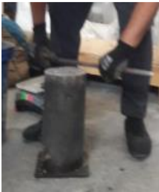
Fig. 33 Enrazado del agregado en el ensayo de peso unitario compactado.
