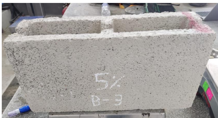
Fig. 50 Preparación de las unidades de albañilería, para el ensayo de resistencia a la compresión.
