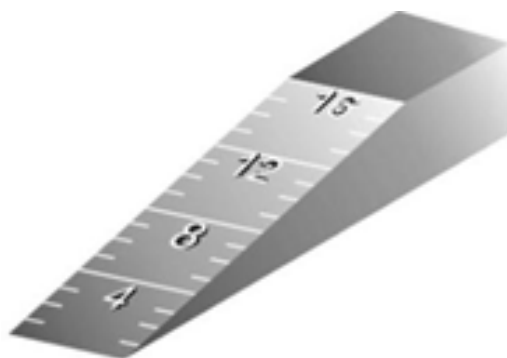
Fig. 20 Cuña de acero para la medición del alabeo de unidades de albañilería.
