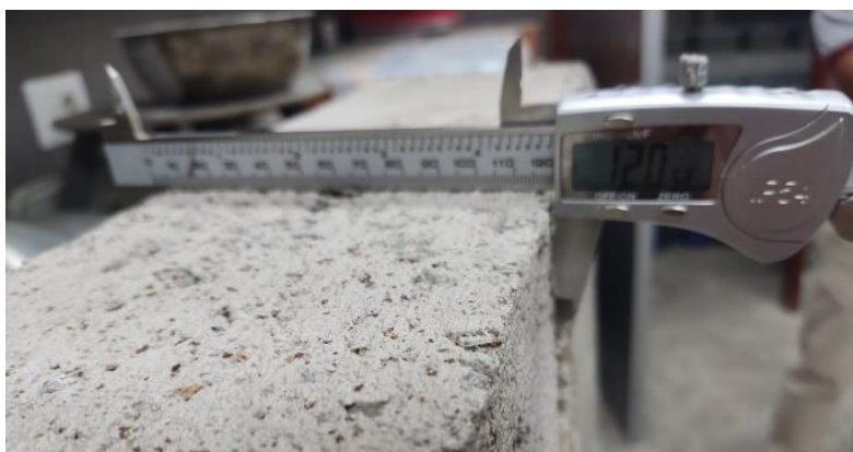
Fig. 45 Toma de datos en el ensayo de variación dimensional.
