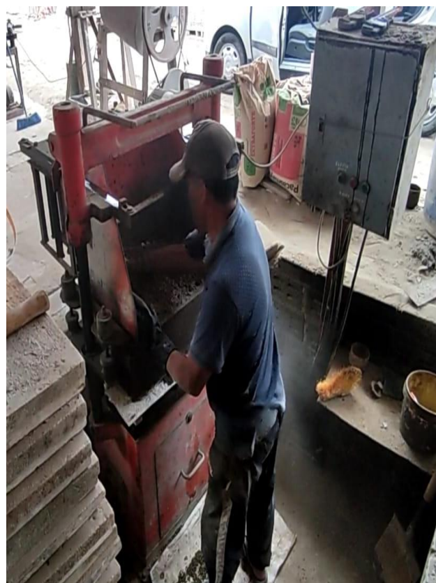
Fig. 39: Nivelación con la mano para llenar todo los espacios del molde
