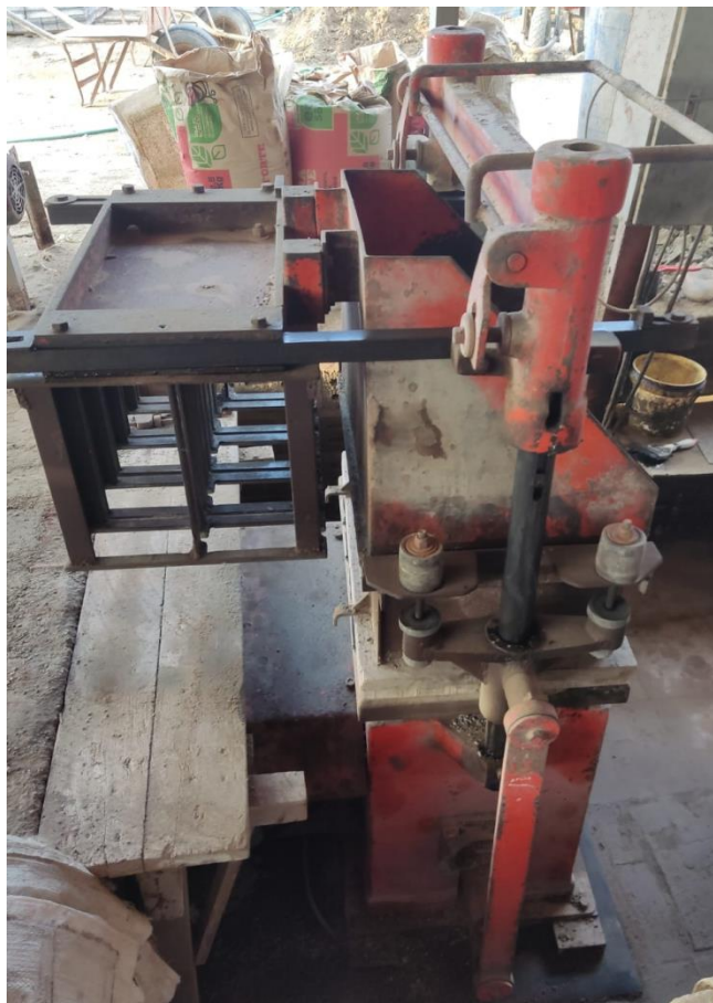
Fig. 35: MÁQUINA BLOQUETERA TIPO MILANO M-1 ELÉCTRICO de sistema VIBRO – COMPRIMIDO
