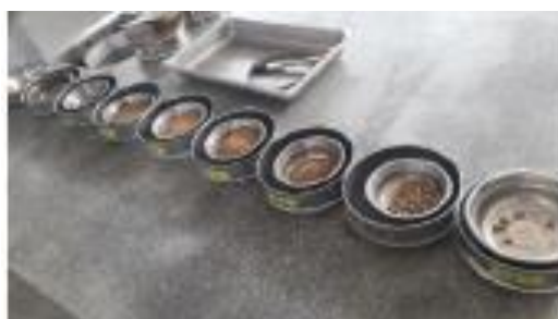
Fig. 29 Cuantificación del agregado fino retenido en los tamices.
