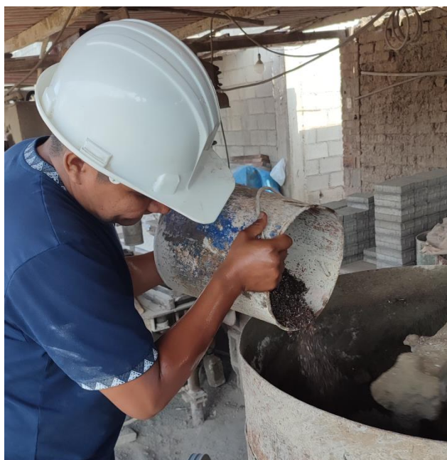
Fig. 34 Dosificación de los materiales para fabricación de unidades de albañilería
