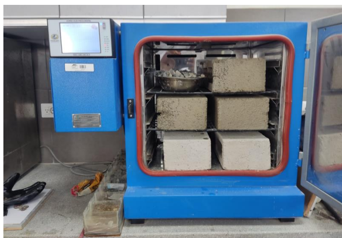
Fig.49 Ladrillos de concreto en el horno a 110°C
