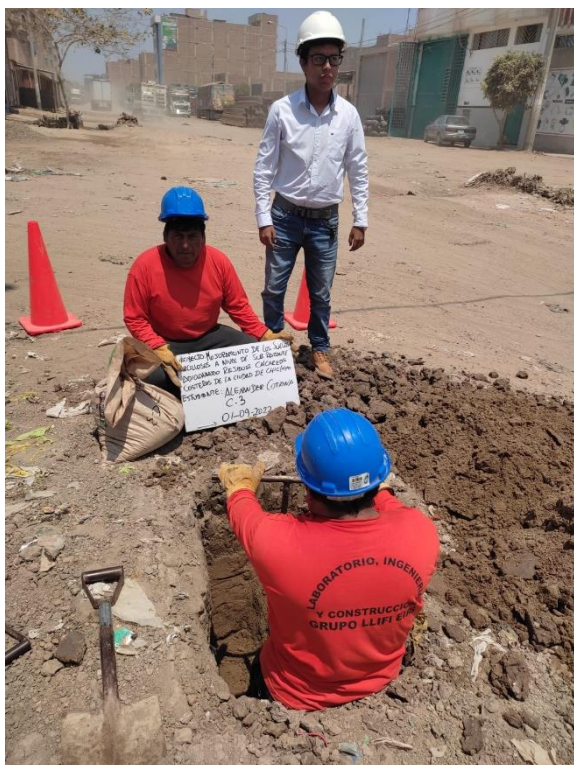
Ilustración N°2.7: Ejecución de Calicata 03. Fuente: Propia
