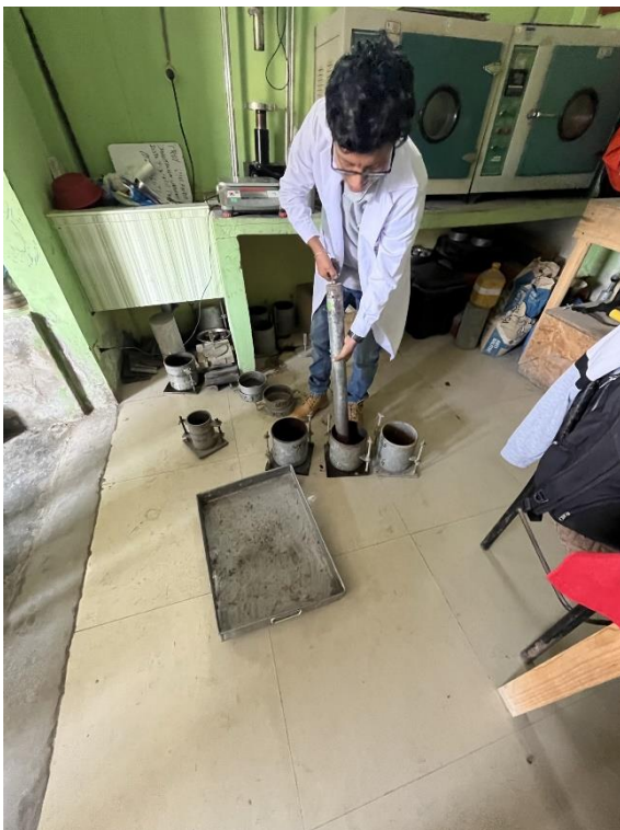
Ilustración N°2.20: Llenado de molde de compactación con muestra natural ensayo Proctor Fuente: Propia
