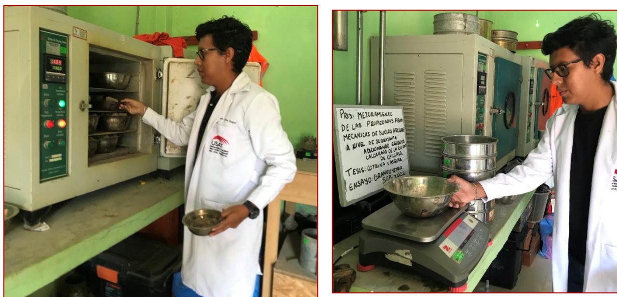
Figura 11: Ensayo de humedad. Fuente: Propia
