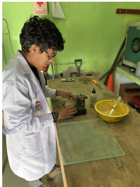
Ilustración N°2.15: Colocación de muestra natural en cuchara de Casagrande – ensayo limite líquido. Fuente: Propia
