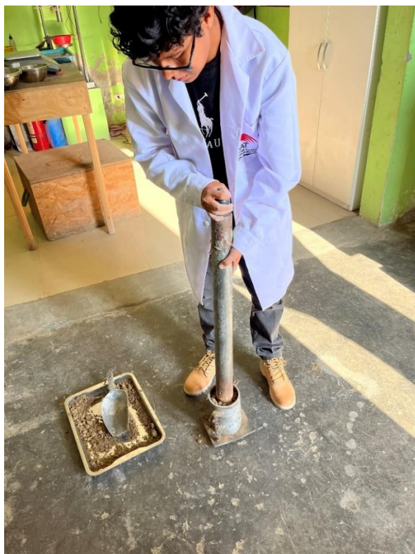
Figura 15: Ensayo Proctor modificado. Fuente: Propia
