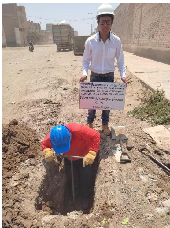
Ilustración N°2.7: Ejecución de Calicata 03. Fuente: Propia
