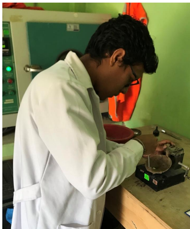
Figura 13: Ensayo límite líquido. Fuente: Propia
