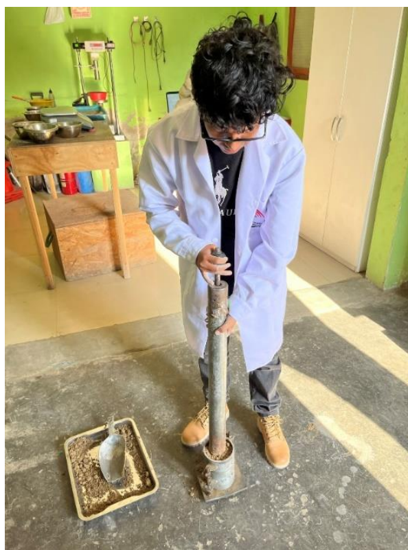
Figura 15: Ensayo Proctor modificado. Fuente: Propia
