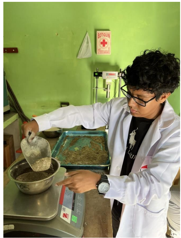
Ilustración N°2.14: Registro de peso inicial muestra natural - ensayo de humedad natural. Fuente: Propia
