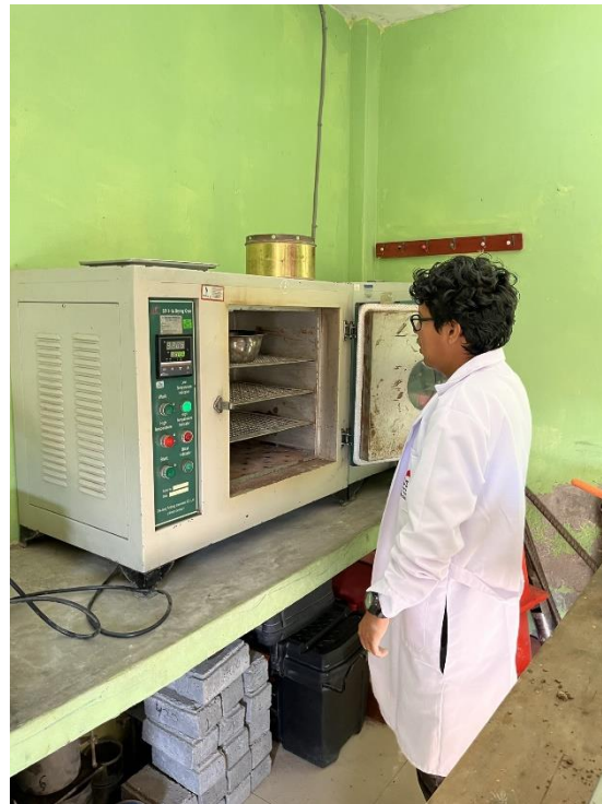
Ilustración N°2.13: Colocación de muestra al horno - ensayo de humedad natural. Fuente: Propia
