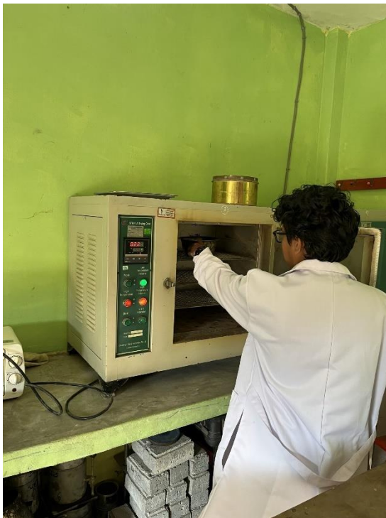
Ilustración N°2.13: Colocación de muestra al horno - ensayo de humedad natural. Fuente: Propia
