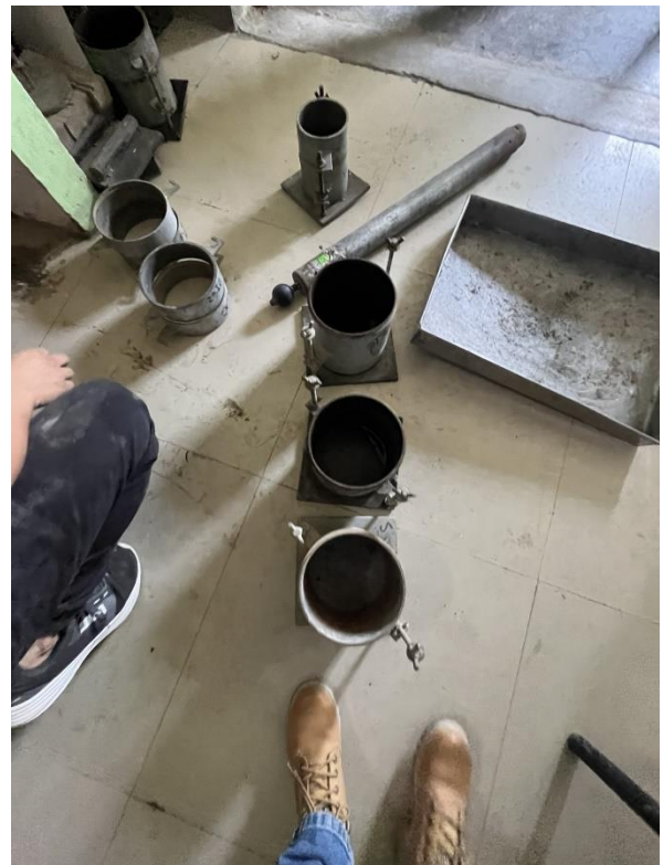
Ilustración N°2.20: Llenado de molde de compactación con muestra natural ensayo Proctor Fuente: Propia
