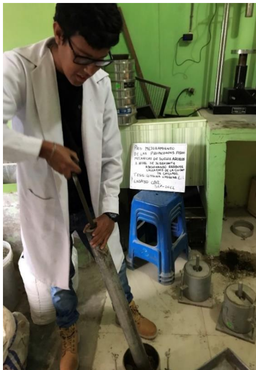
Figura 16: Ensayo de CBR. Fuente: Propia
