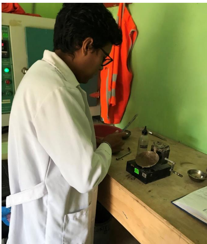
Figura 13: Ensayo límite líquido. Fuente: Propia
