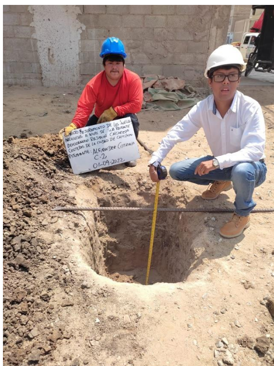
Ilustración N°2.6: Ejecución de Calicata 02. Fuente: Propia
