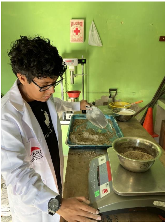
Ilustración N°2.14: Registro de peso inicial muestra natural - ensayo de humedad natural. Fuente: Propia
