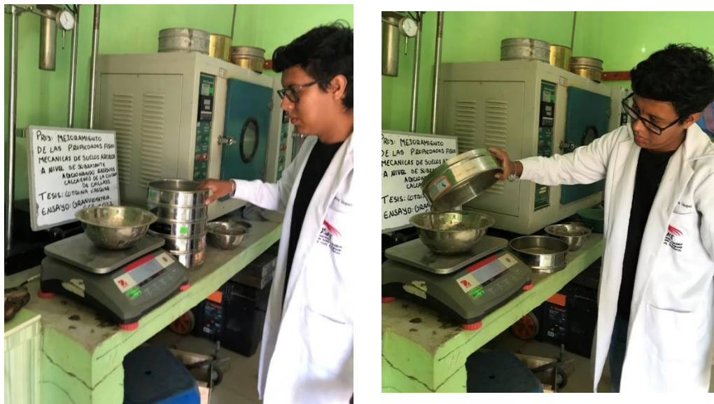
Figura 12: Ensayo granulometría por tamizado. Fuente: Propia
