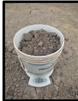
*Figura N° 48 Pesaje de tierra para la primera dosificación.*
