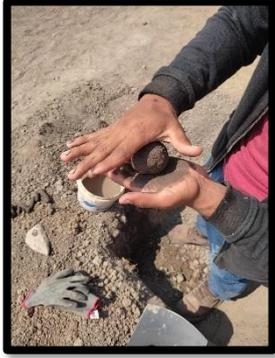
*Figura N° 15 Prueba de Resistencia Seca.*
