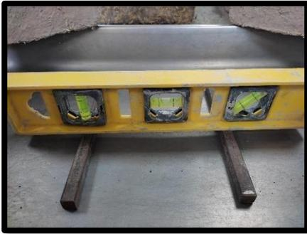
*Figura N° 77 Nivel utilizado para nivelar el área de contacto.*
