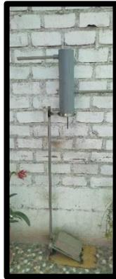
*Figura N° 85 Aparato de erosión acelerada.*
