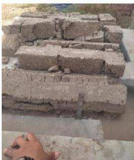
*Figura N° 107 Colapso del muro.*
