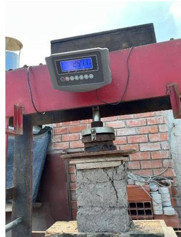
*Figura N° 92 Falla del muro o pila a compresión.*
