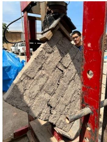
*Figura N° 98 Ensayo a Compresión Diagonal.*
