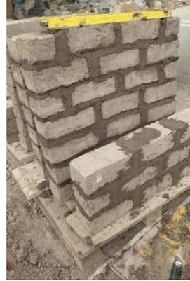
*Figura N° 94 Muestras para el ensayo a Compresión Diagonal.*
