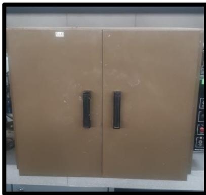
*Figura N° 19 Horno utilizado para hallar el contenido de humedad.*
