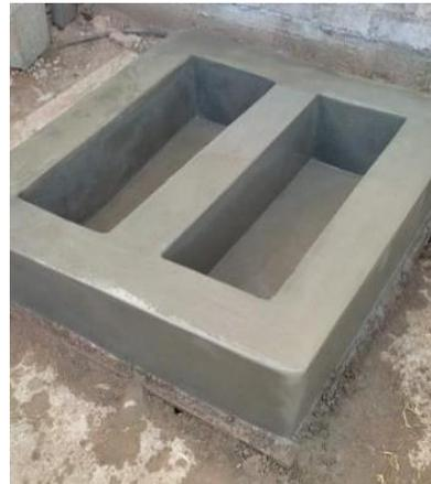
*Figura N° 100 Construcción de poza para el ensayo de Inundación Simulada.*
