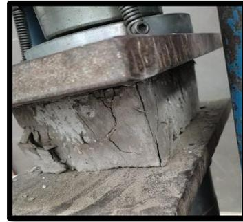
*Figura N° 70 Rotura (Unidades adicionadas con diatomeas y fibras).*
