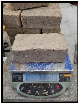
*Figura N° 79 Pesaje de la muestra seca.*
