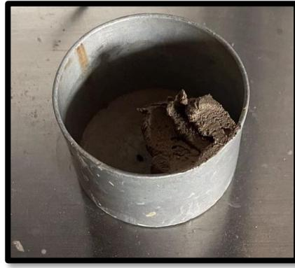
*Figura N° 32 Muestra para determinar el límite líquido.*
