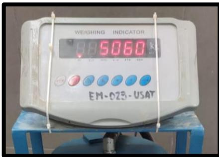
*Figura N° 71 Resistencia a compresión (unidades adicionadas con diatomeas y fibras).*
