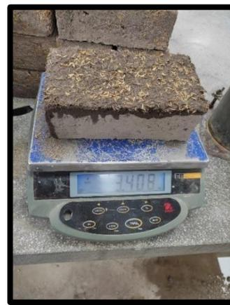
*Figura N° 80 Pesaje de la muestra húmeda.*
