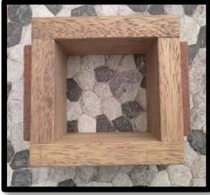
*Figura N° 33 Molde utilizado para realizar los cubos.*
