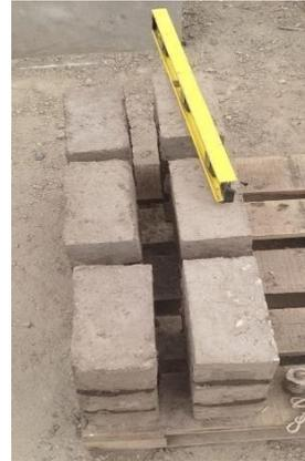
*Figura N° 90 Muestras para el ensayo de compresión a pilas.*
