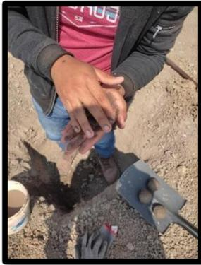
*Figura N° 12 Prueba de Cinta de Barro.*
