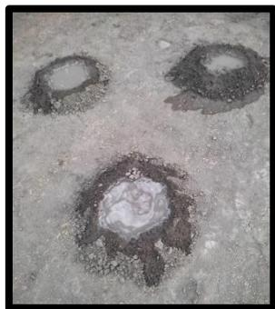
*Figura N° 50 Hidratación previa para unidades adicionadas con diatomeas.*
