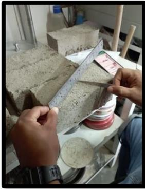
*Figura N° 83 Toma de medidas para determinar el alabeo.*
