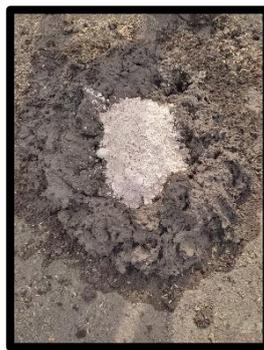
*Figura N° 51 Mezcla de barro con diatomeas en distintas dosificaciones.*
