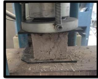
*Figura N° 35 Rotura (Cubos).*
