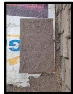
*Figura N° 53 Molde enrazado.*
