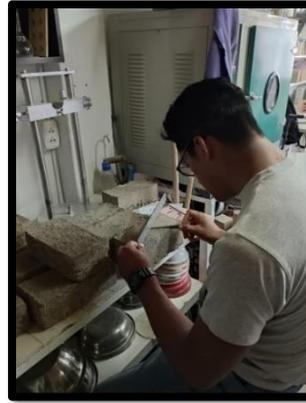
*Figura N° 82 Toma de medidas para determinar el alabeo.*
