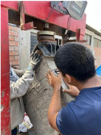
*Figura N° 97 Ensayo a Compresión Diagonal.*
