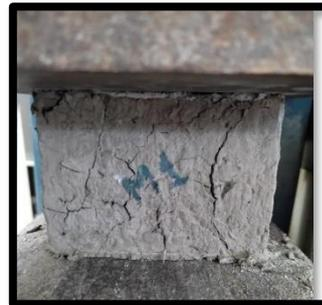
*Figura N° 68 Rotura (Unidades adicionadas con diatomeas).*
