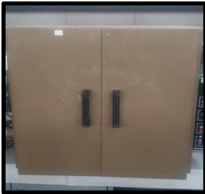
*Figura N° 31 Horno utilizado para determinar los límites.*
