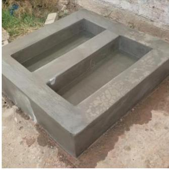
*Figura N° 101 Prueba de estanqueidad.*
