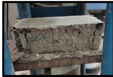
*Figura N° 72 Rotura (Unidades adicionadas con diatomeas y fibras).*
