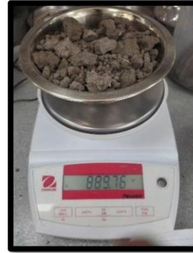
*Figura N° 18 Peso de la Muestra Húmeda.*
