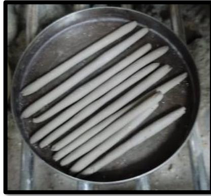
*Figura N° 30 Muestra para determinar el límite plástico.*
