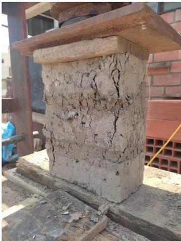
*Figura N° 91 Falla del muro o pila a compresión.*
