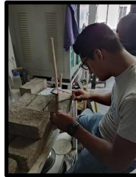
*Figura N° 84 Toma de medidas para determinar el alabeo.*
