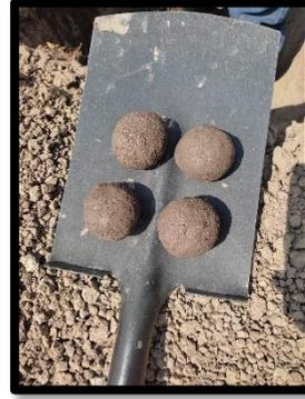
*Figura N° 16 Prueba de Resistencia Seca.*
