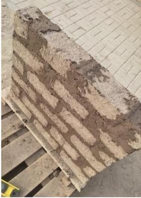
*Figura N° 93 Muestras para el ensayo a Compresión Diagonal.*
