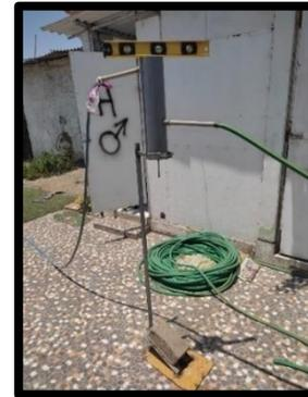
*Figura N° 86 Nivelado del aparato de erosión acelerada.*
