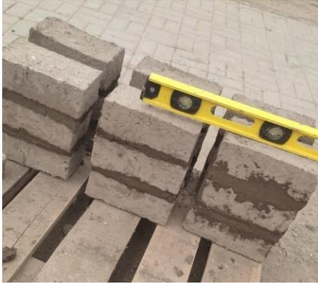
*Figura N° 89 Muestras para el ensayo de compresión a pilas.*
