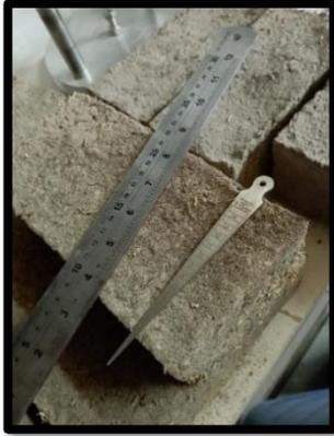
*Figura N° 81 Regla y cuña milimetrada utilizada en la medición.*
