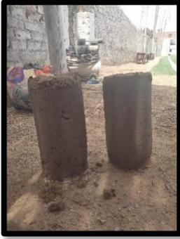
*Figura N° 42 Probetas esperando curado.*
