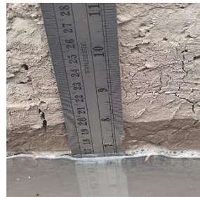
*Figura N° 106 Toma de la capilaridad con regla milimetrada.*
