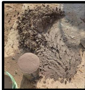
*Figura N° 40 Vaciado de las probetas de tierra.*
