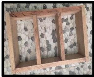
*Figura N° 46 Molde para unidades de tierra reforzada convencional y con adiciones.*
