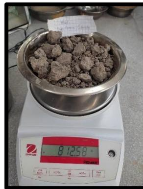
*Figura N° 20 Peso de la Muestra Seca.*
