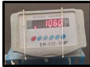
*Figura N° 37 Resistencia a compresión (cubos).*
