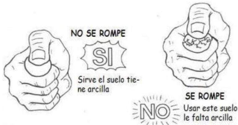
Figura N° 2 Consideraciones de la prueba de resistencia seca
