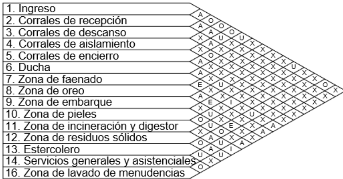
Figura 19. Diagrama de distribución del matadero municipal de Pacora
