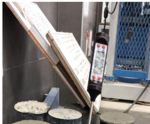
*Figura 85 Temperatura del concreto
