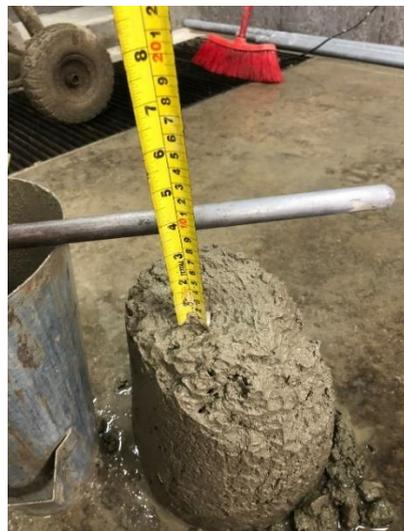
*Figura 44 Asentamiento del concreto*
