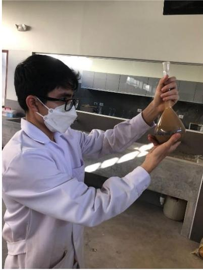
*Figura 20 Eliminación de las burbujas de aire atrapado*
