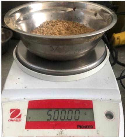
*Figura 12 Muestra húmeda de agregado fino*
