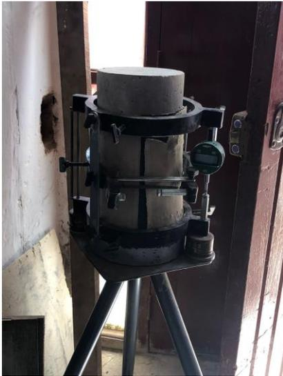
*Figura 56 Espécimen con deformímetro*
