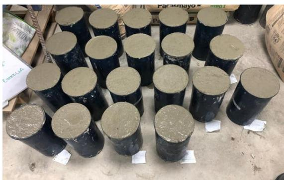
Figura 68 Elaboración de especímenes  $a/c=0.555$
