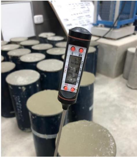
*Figura 80 Temperatura del concreto patrón  $a/c=0.6$*
