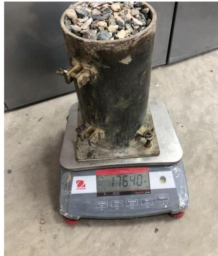
*Figura 29 Peso del agregado grueso en la probeta*
