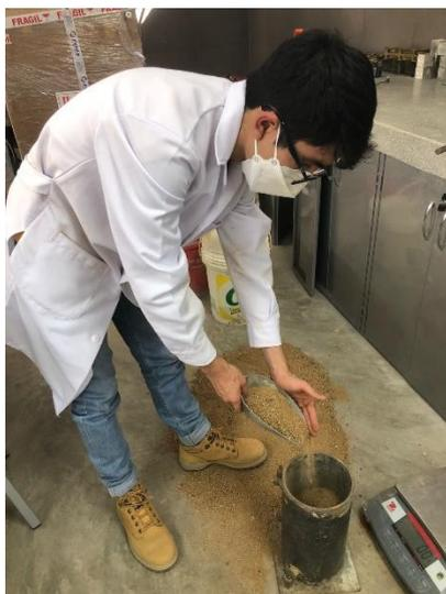
*Figura 26 Colocación de muestra de agregado fino*
