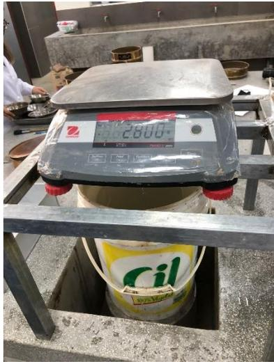
*Figura 24 Peso de agregado con canastilla*
