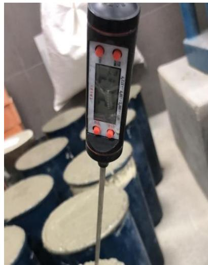
*Figura 48 Control de temperatura del concreto*
