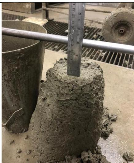
Figura 78 Asentamiento del concreto
