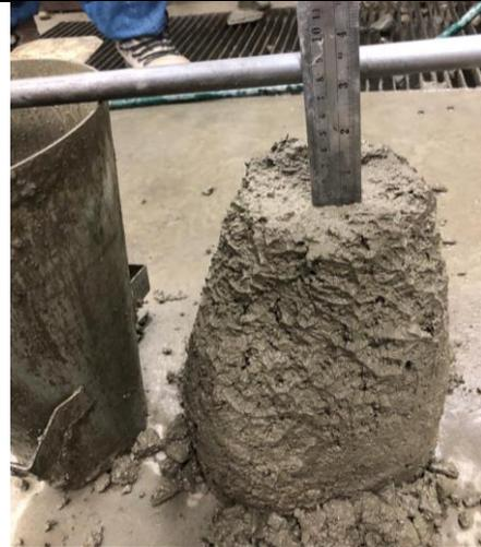
Figura 72 Asentamiento del concreto
