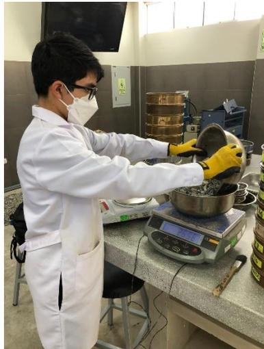
*Figura 10 Muestra agregado grueso*
