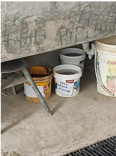
*Figura 22 Agregado sumergido en agua*
