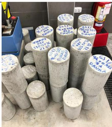
Figura 69 Especímenes adicionales expuestos al ambiente
