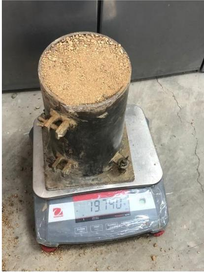
*Figura 32 Peso del agregado fino en la probeta*
