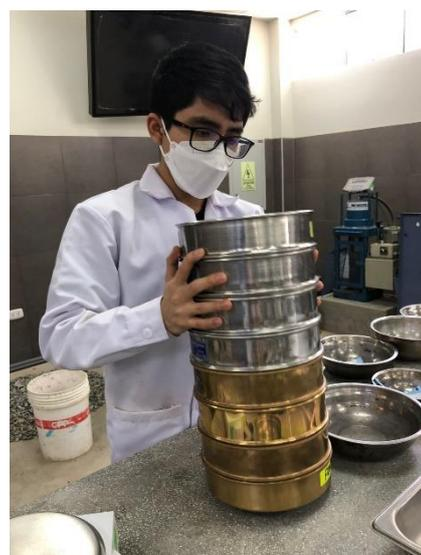
Figura 7 Tamizado del agregado fino
