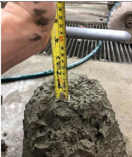
Figura 73 Asentamiento del concreto
