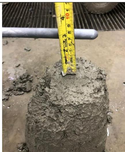
Figura 79 Asentamiento del concreto
