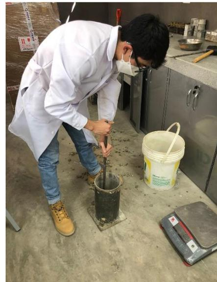
*Figura 31 Compactando la muestra de agregado grueso*
