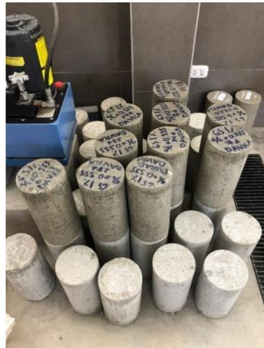
*Figura 51 Especímenes expuestos a la intemperie*
