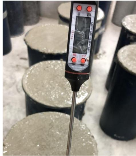
*Figura 81 Temperatura del concreto  $a/c=0.6 + G.S. 0.1\%$*
