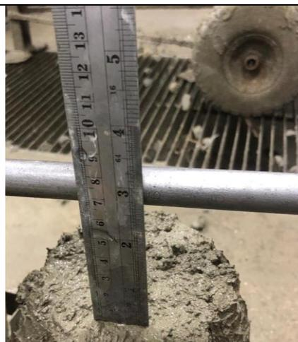
Figura 77 Asentamiento del concreto
