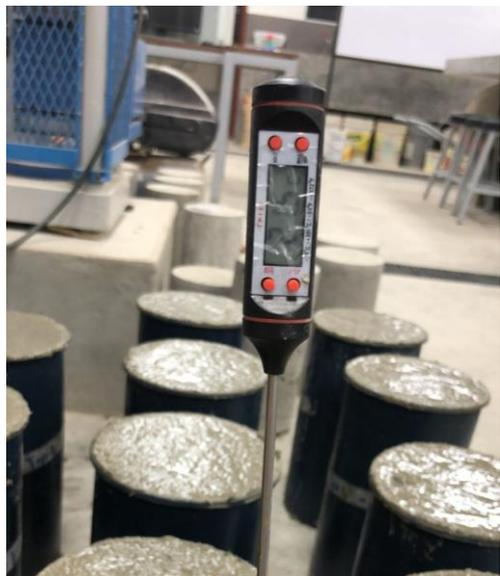
*Figura 86 Temperatura del concreto
