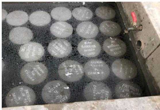
Figura 67 Curado de especímenes patrón
