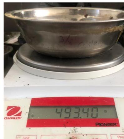
*Figura 15 Muestra seca del agregado fino*
