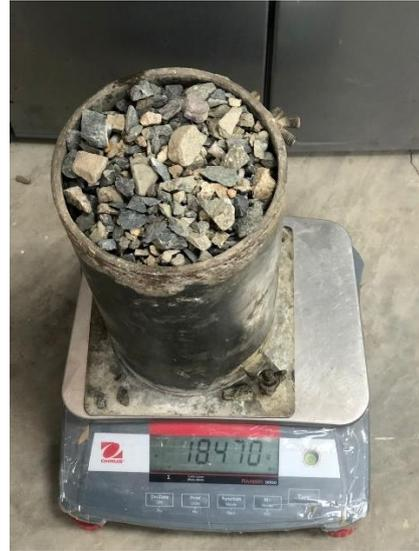
*Figura 33 Peso del agregado grueso en la probeta*
