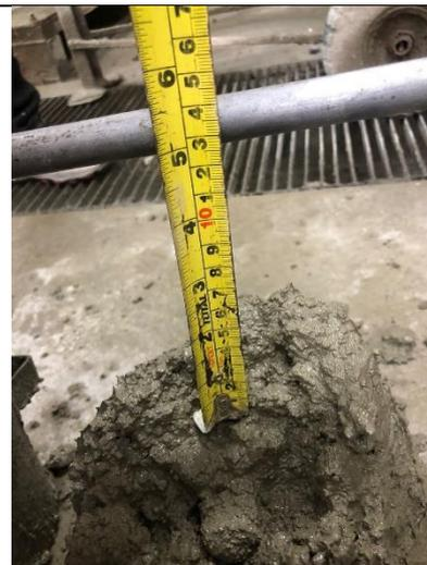
Figura 74 Asentamiento del concreto
