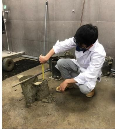
Figura 70 Medición asentamiento  $a/c=0.6$
