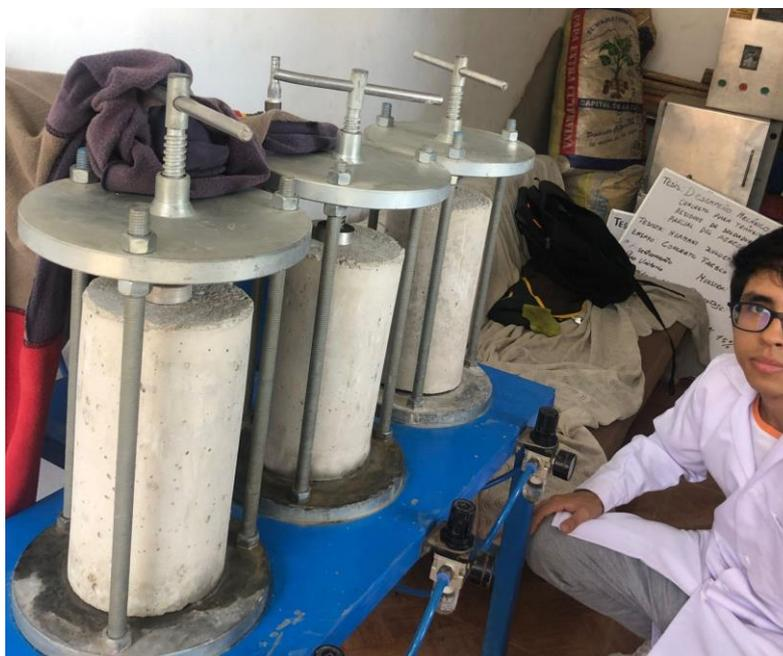
*Figura 60 Muestras para ensayo permeabilidad*
