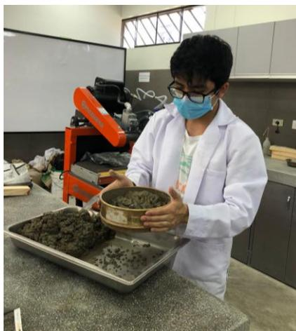
*Figura 45 Tamizado del concreto por la malla N° 4*
