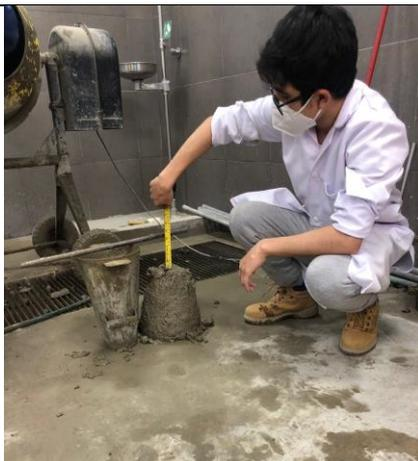
Figura 75 Medición asentamiento  $a/c=0.555$
