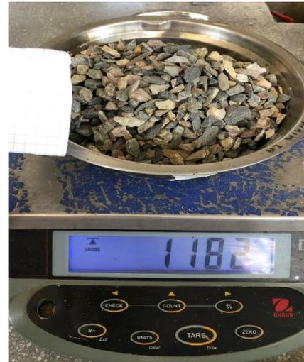
*Figura 11 Peso del agregado retenido*
