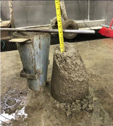
Figura 71 Asentamiento del concreto patrón
