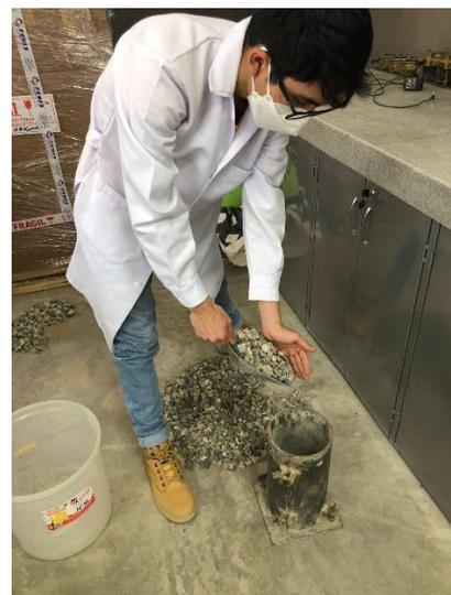
*Figura 27 Colocación de muestra de agregado grueso*
