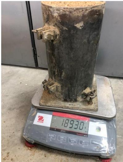
*Figura 28 Peso del agregado fino en la probeta*
