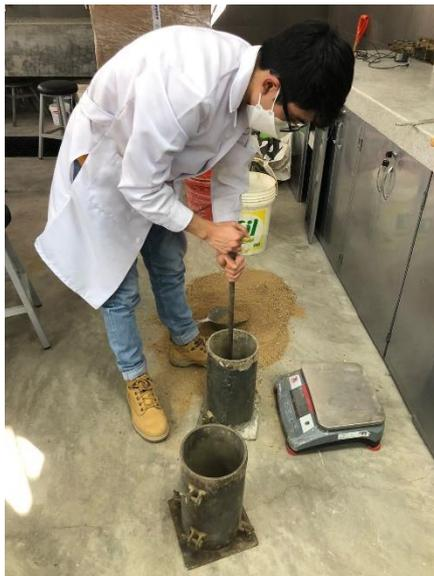
*Figura 30 Compactando la muestra de agregado fino*
