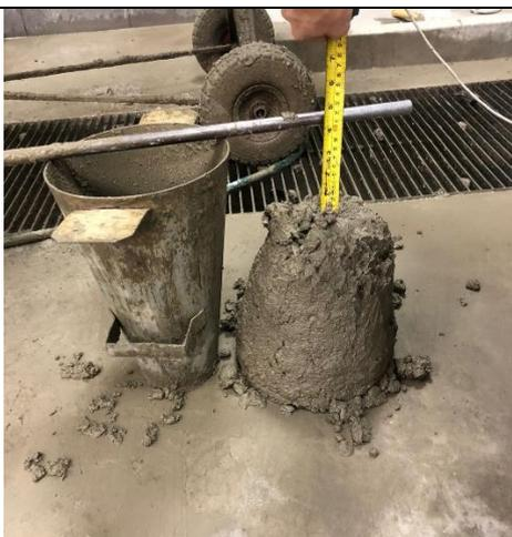
Figura 76 Asentamiento del concreto patrón
