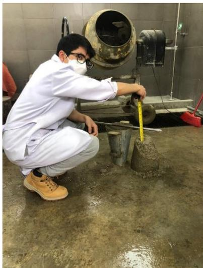
*Figura 43 Medición del asentamiento*
