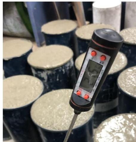
*Figura 83 Temperatura del concreto  $a/c=0.6 + G.S. 1\%$*
