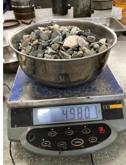
*Figura 17 Muestra seca de agregado grueso*
