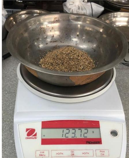
*Figura 9 Peso de agregado retenido*
