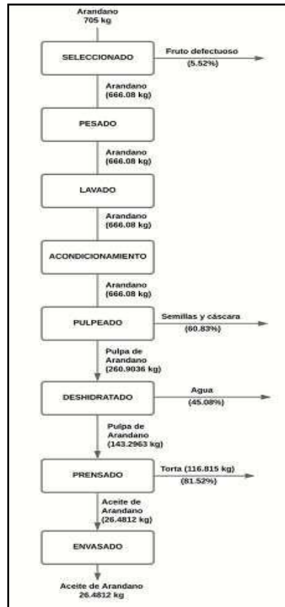
Figura 1. Diagrama de balance materia del proceso de extracción de aceite de arándanos Fuente: Elaboración Propia
