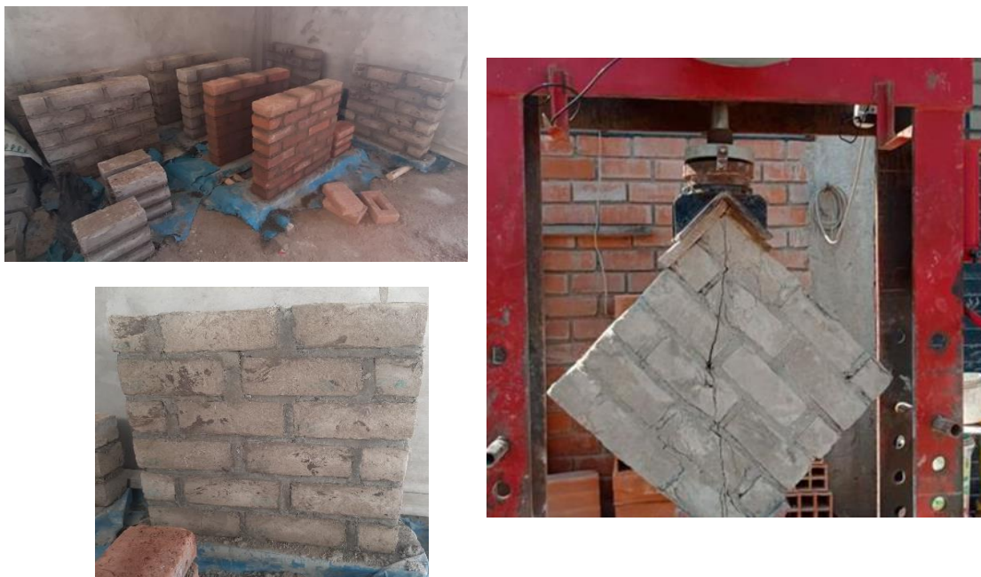
Ilustración 33: Elaboración de Muretes de las Unidades Propuestas y Convencionales
