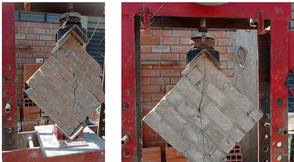
Ilustración 35: Falla de Muretes de Ladrillos convencionales y Unidades Propuestas
