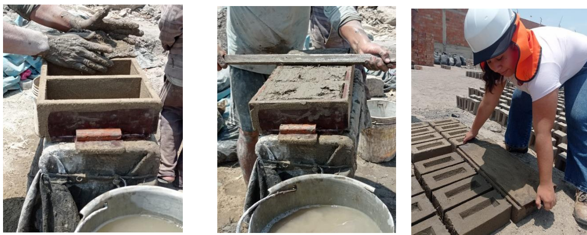
Ilustración 25: Moldeado de las Unidades Propuestas
