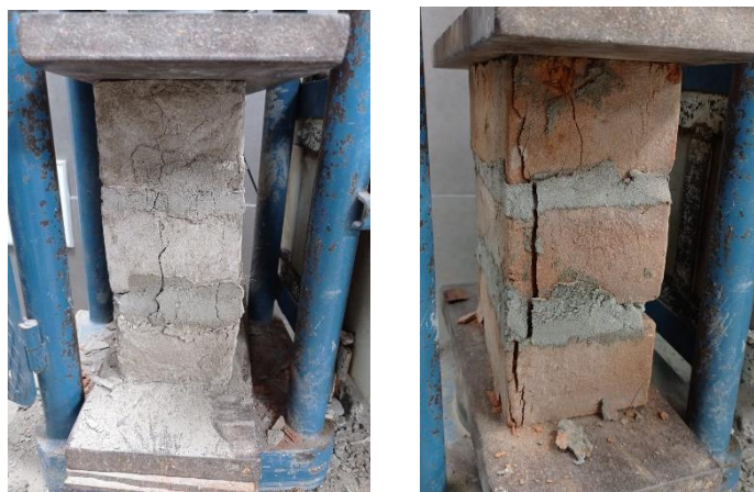
Ilustración 36: Falla de Pilas de ladrillos convencionales y unidades propuestas
