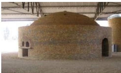
Ilustración 3: Horno de Fuego Dormido
