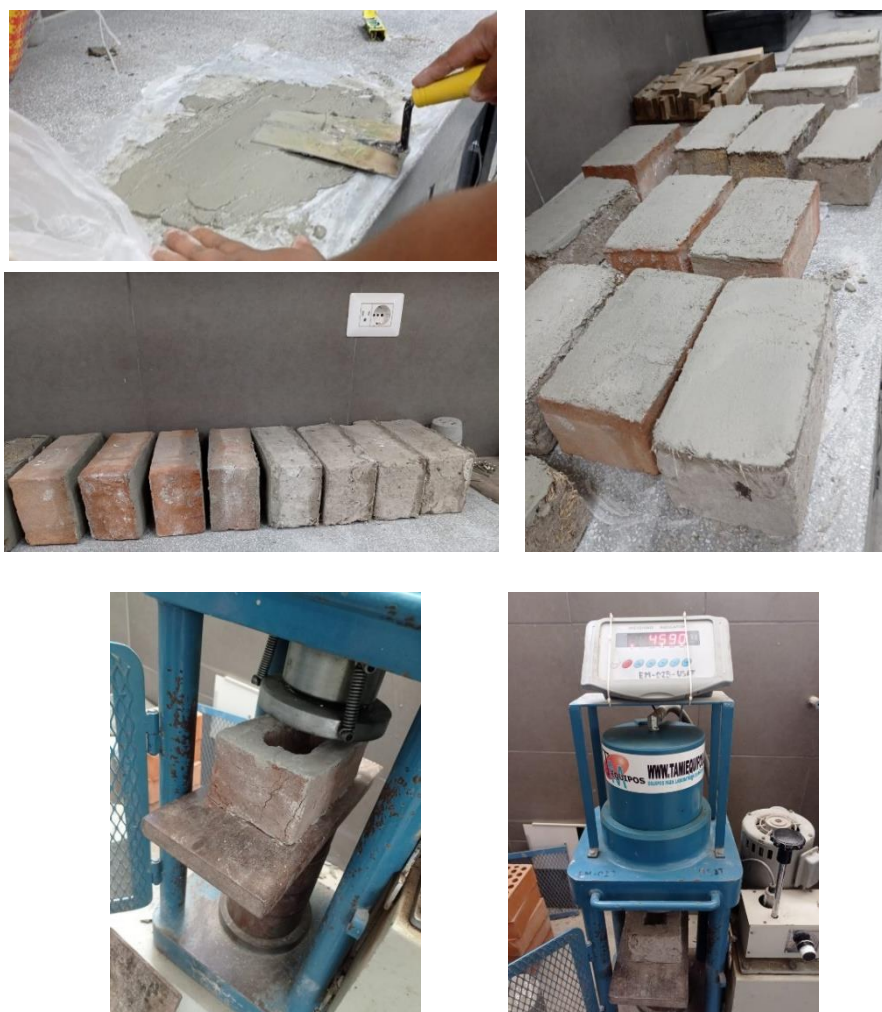
Ilustración 32: Ensayo de Resistencia a la Compresión de las Unidades Propuestas y Convencionales
