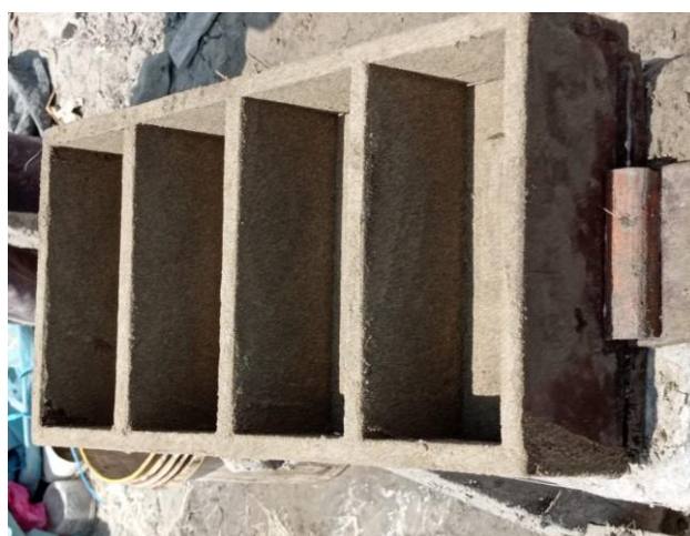
Ilustración 24: Molde para las Unidades Propuestas
