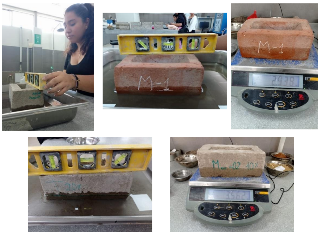
Ilustración 31: Ensayo de Succión de las Unidades Propuestas y Convencionales
