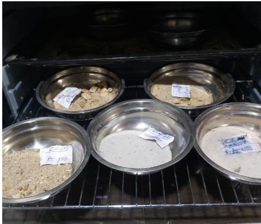
FOTOGRAFÍA 32: ENSAYO DE CONTENIDO DE HUMEDAD
