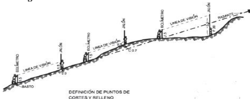
Figura N°5. Trazado directo en una carretera
