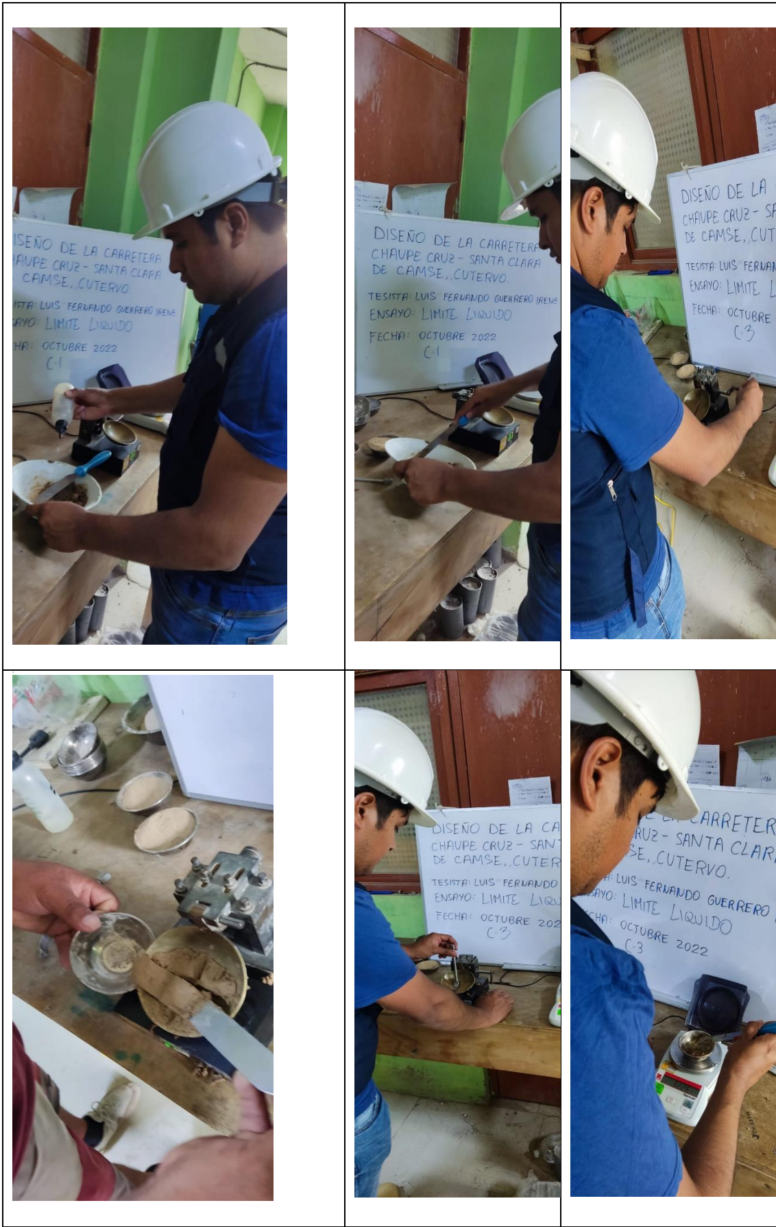
FOTOGRAFÍA 38: ENSAYO LÍMITES DE ATTENBERG
