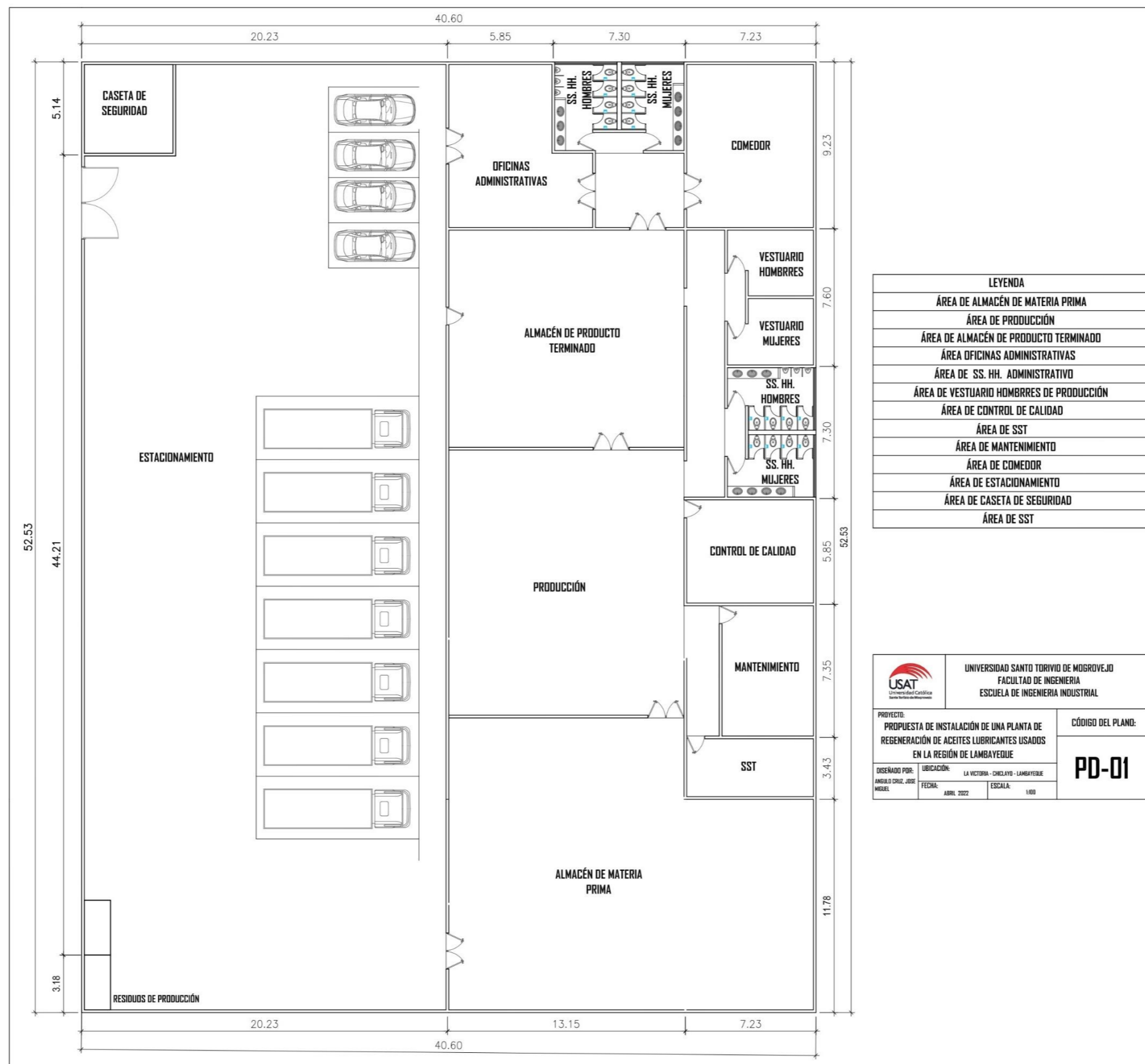
Figura 20 A. Plano de distribución de la planta regeneradora de aceites lubricantes usados
