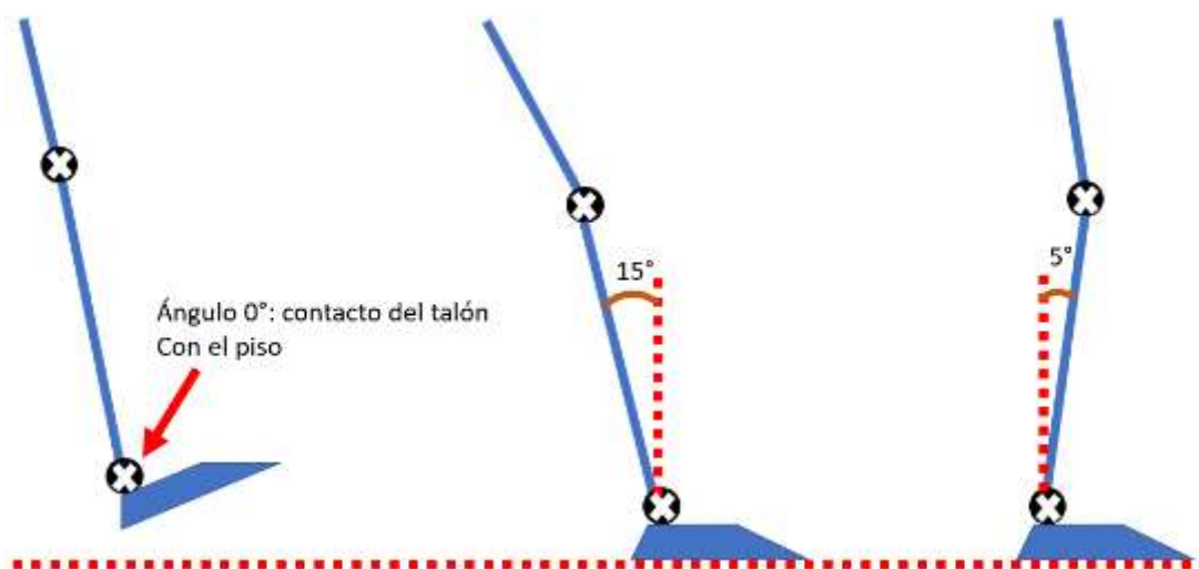
Ilustración 2: Ángulos de movimiento del tobillo en la fase 1.
