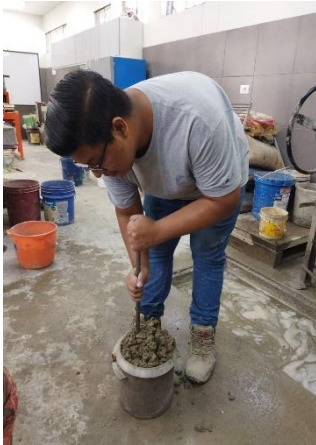
Figura 11. Llenado de la olla de Washington.
