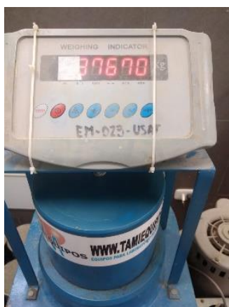
Figura 21. Carga máxima a la compresión que resistió el testigo.
