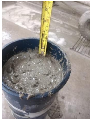
Figura 13. Llenado de molde dejando un borde libre de dos pulgadas.
