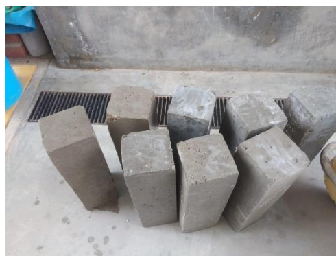
Figura 20. Vigas utilizadas en el ensayo de resistencia a la flexión.
