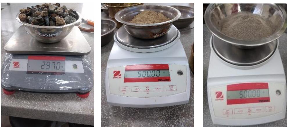
Figura 7. Muestras utilizadas para ensayo de peso específico y absorción.
