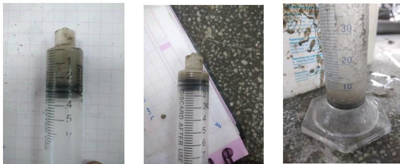
Anexo 56.2. Exudación C.Experimental f'c 210 kg/cm 2 – tipo V.
