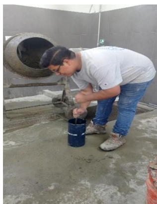
Figura 17. Llenado y compactado del concreto en el molde.
