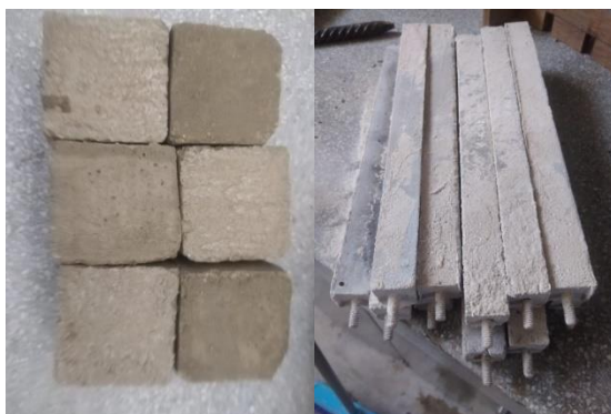
Figura 28. Cubos y barras para ensayo de durabilidad a los sulfatos.
