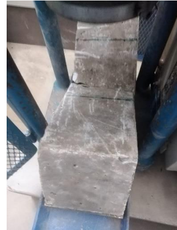
Figura 24. Rotura de la viga en el tercio medio.
