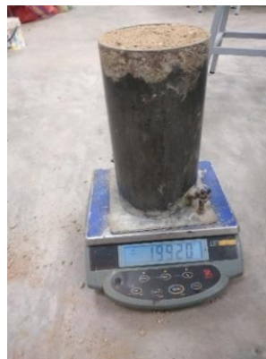
Figura 6. Peso volumétrico compactado del agregado fino
