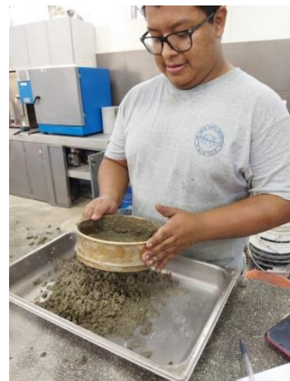
Figura 16. Tamizado del concreto por la malla #4.
