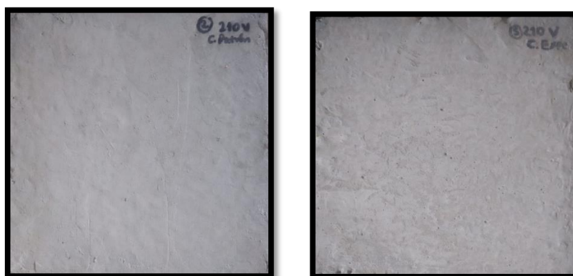
Figura 30. Losas sin fisuras elaboradas con CP y CE f'c 210 kg/cm 2 V.
