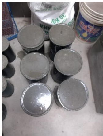
Figura 19. Testigos usados en el ensayo de resistencia a la compresión.
