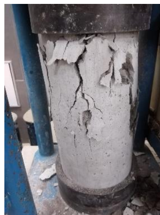
Figura 22. Falla del testigo causada por la carga.
