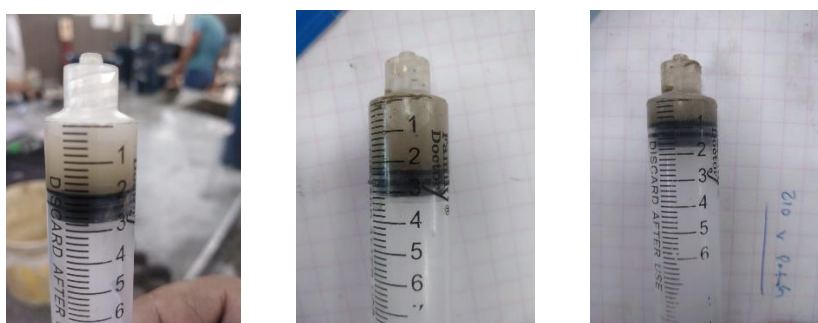
Anexo 56.2. Exudación C.Patrón f°c 210 kg/cm 2 – tipo V.
