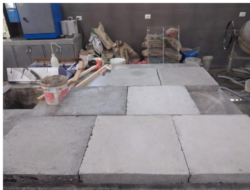
Figura 27. Losas elaboradas para evaluar el fisuramiento.
