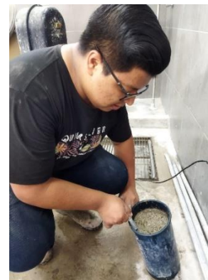
Figura 14. Extracción de agua exudada.
