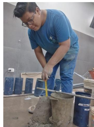
Figura 10. Slump del concreto experimental f'c = 175 \text{ kg/cm}^2 con cemento tipo I.
