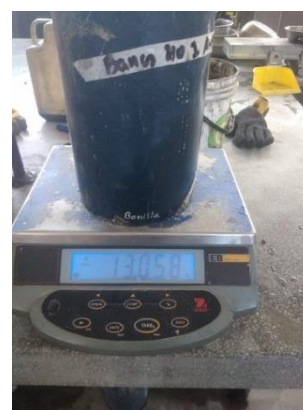
Figura 18. Peso del concreto incluido el molde.
