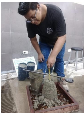
Figura 9. Slump del concreto patrón f'c = 175 \text{ kg/cm}^2 con cemento tipo I.
