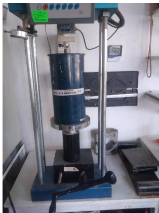
Figura 15. Máquina de Marshall la cual va cumplir la función de penetrómetro.
