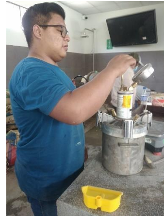
Figura 12. Bombeo de aire en la olla de Washington.
