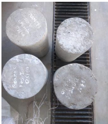
Figura 25. Probetas cilíndricas realizadas para el ensayo de resistencia al desgaste.
