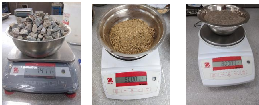
Figura 3. Muestras húmedas de los áridos para ensayo de humedad.
