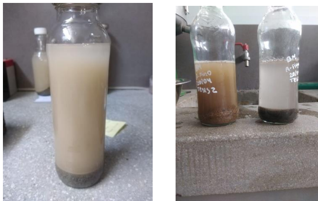
Figura 8. Muestras de agregados sumergidas en agua destilada para ensayo de contenido de sales solubles.
