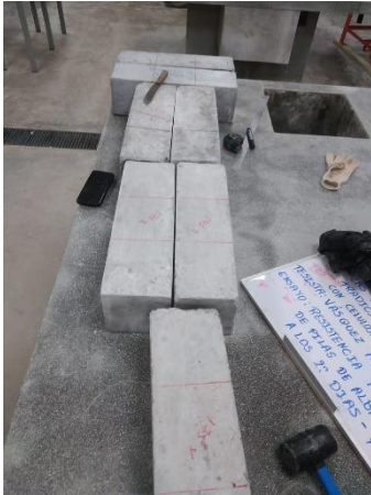
Figura 23. Marcado de los tres tercios de las vigas.
