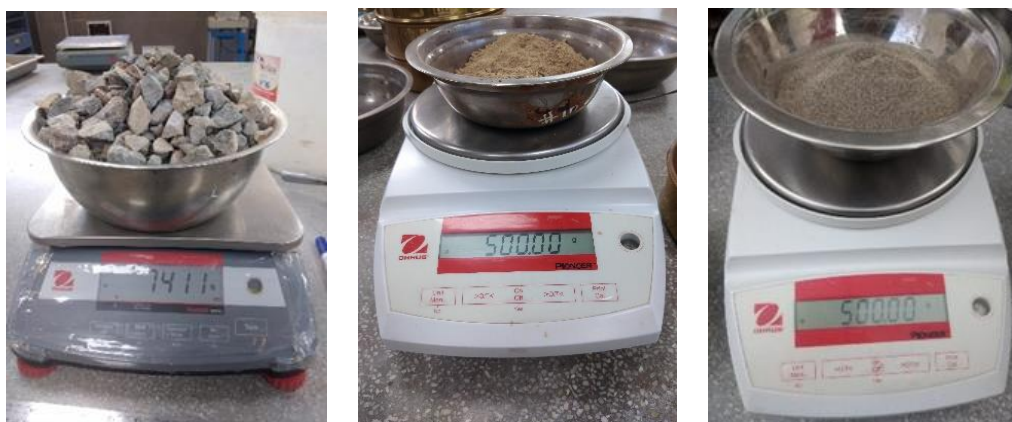
Figura 4. Muestras de los agregados utilizadas para el ensayo de granulometría.
