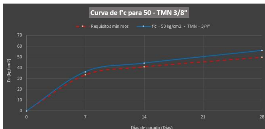
Gráfico N°9. Curva de F'c = 50 \text{ kg/cm}^2 en bloques de concreto con 0% de caucho
