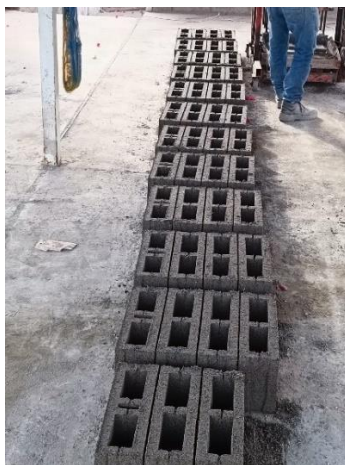
Figura N°73. Bloques de concreto con diferentes proporciones de caucho
