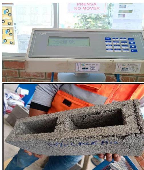
Figura N°46. Resistencia a los 28 días
