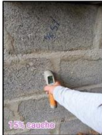
Figura N°126. Termómetro en la cara externa 15%
