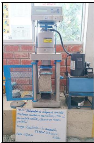
Figura N°39. Bloque de concreto en la máquina con 5% de caucho
