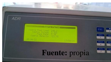
Figura N°37. Resistencia a los 14 días
