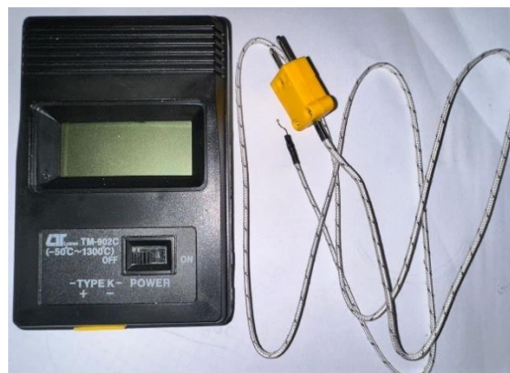
Figura N°4. Sensor y termocupla tipo k.
