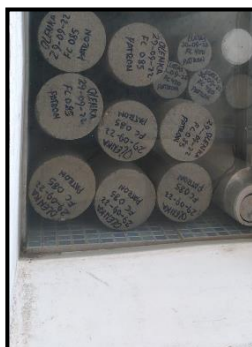
Figura N°23. Curado de probetas
