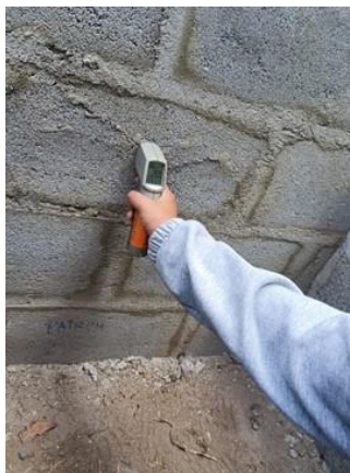
Figura N°107. Termómetro en la cara interna con 0%
