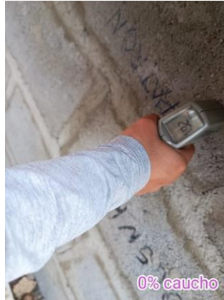
Figura N°124. Termómetro en la cara externa 0%
