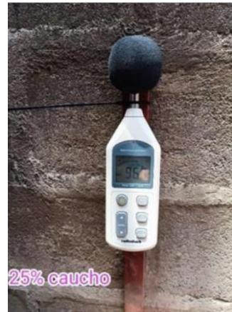
Figura N°89. Sonómetro en la cara interna 25% caucho
