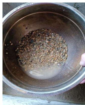
Figura N°17. Lavado del agregado fino
