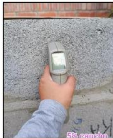
Figura N°125. Termómetro en la cara externa 5%
