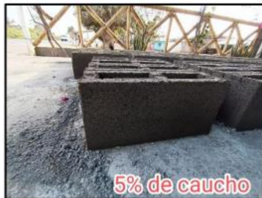
Anexo 5.6: Bloques de concreto con incorporación de caucho reciclado.
