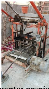
Figura N°29. Compactando la mezcla
