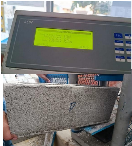
Figura N°38. Resistencia a los 28 días
