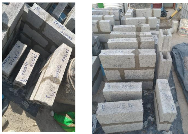
Figura N°62. Muretes con el 0%,5%,15% y 25% de caucho
