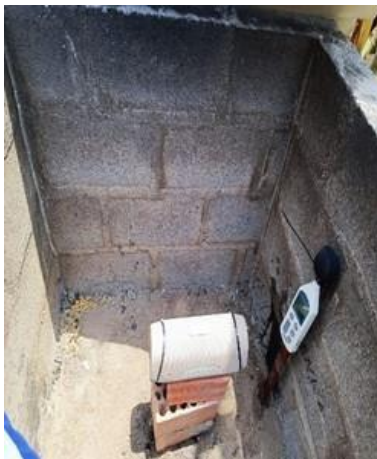
Figura N°82. Ensayo con el radio y el sonómetro
