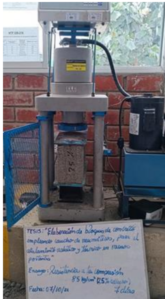
Figura N°47. Bloque de concreto en la máquina con 25% de caucho
