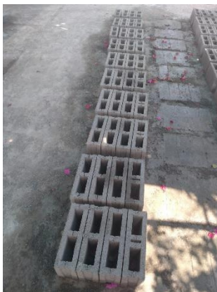
Figura N°34. Secado de los bloques de concreto
