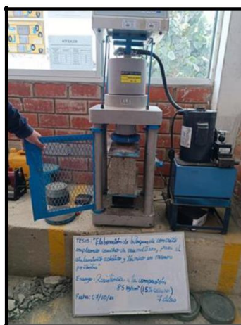
Figura N°43. Bloque de concreto en la máquina con 15% de caucho
