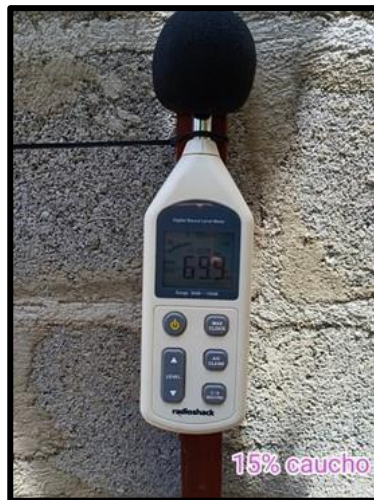
Figura N°92. Sonómetro en la cara externa con 15% de caucho
