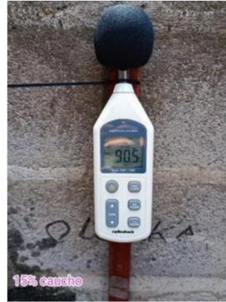
Figura N°88. Sonómetro en la cara interna 15% caucho
