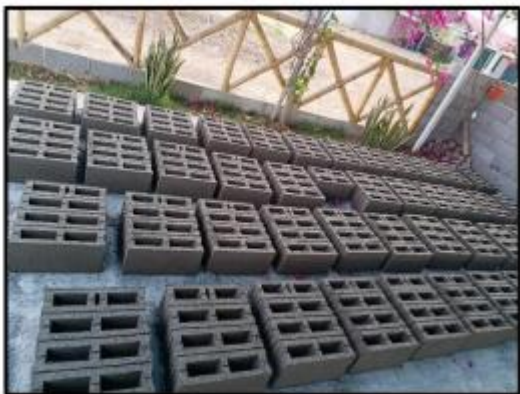
Anexo 5.5: Bloques de concreto con incorporación de caucho reciclado.
