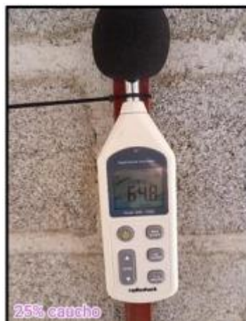
Figura N°93. Sonómetro con la cara externa de 25% de caucho
