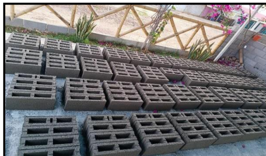
Figura N°32. Fraguado de los bloques de concreto
