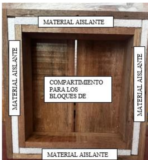
Figura N°11. Equipo para determinar la conductividad
