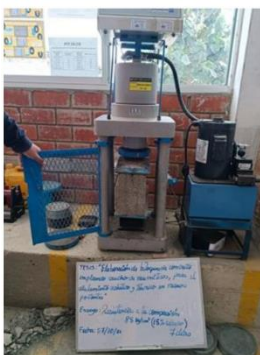
Figura N°35. Bloque de concreto en la máquina con 0% de caucho
