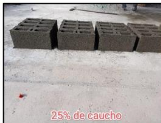
Anexo 5.8: Bloques de concreto con incorporación de 25% caucho reciclado.
