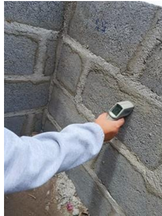
Figura N°108. Termómetro en la cara interna 5%
