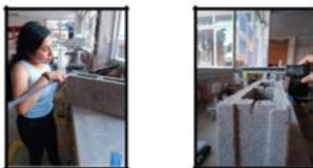
Figura N°60. V. dimensional del espeso del bloque de concreto.
