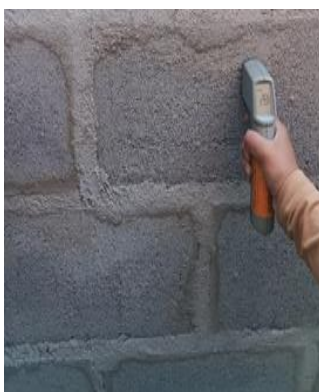
Figura N°104. Termómetro en la cara externa 5%
