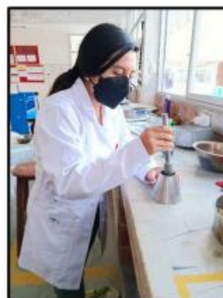
Anexo 1.6: Cono para el ensayo de absorción. Fuente: Propia.
