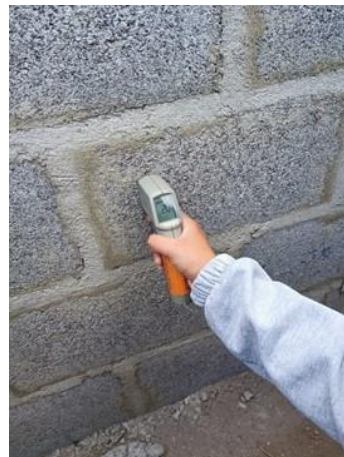
Figura N°110. Termómetro en la cara interna 25%
