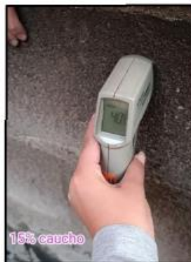
Figura N°122. Termómetro en la cara interna 15%
