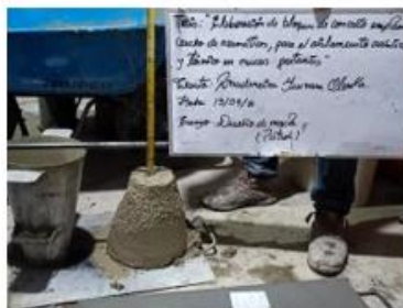
Figura N°22. Vaciado del concreto para slump
