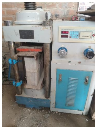
Figura N°67. Máquina para ensayar prismas
