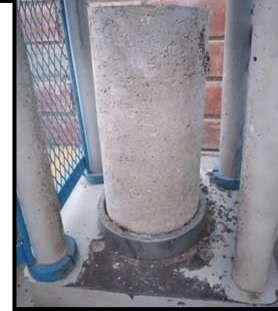
Anexo 4.3: Probetas cilíndricas F'c=50 \text{ kg/cm}^2 14 días. Fuente: Propia.
