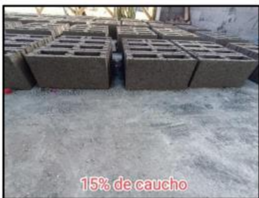
Anexo 5.7 Bloques de concreto con incorporación de 15% caucho reciclado.
