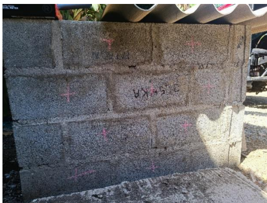
Figura N° 140 Marcación de los 9 puntos en 0% caucho
