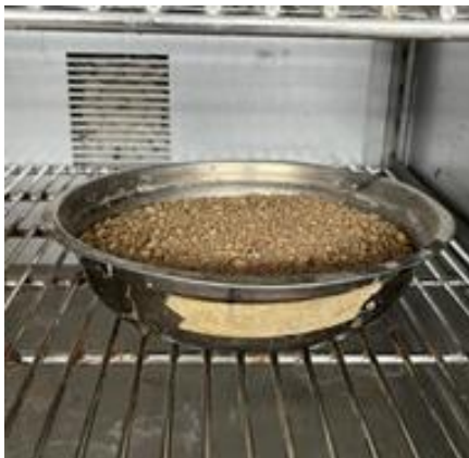
Figura N°18. Secado del agregado fino
