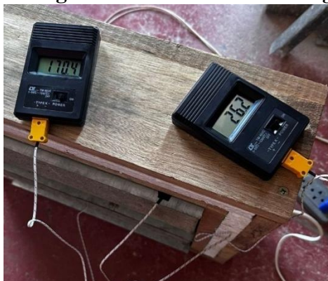
Figura N°9. Termómetros digitales termocupla tipo K
