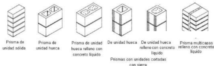
Figura N°13. Construcción de prismas
