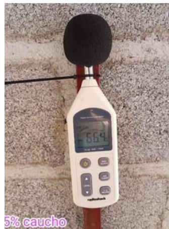
Figura N°91. Sonómetro en la cara externa con 5% de caucho
