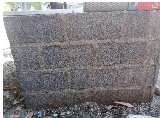
Figura N° 143 Marcación de los 9 puntos en 25% caucho
