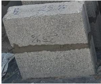
Figura N°14. Pilas en los bloques de concreto
