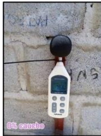
Figura N°90. Sonómetro en la cara exterior
