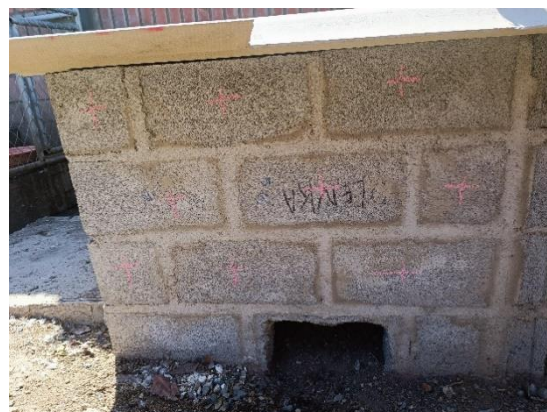
Figura N° 141 Marcación de los 9 puntos en 5% caucho
