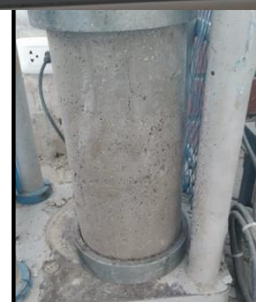
Anexo 4.1 Probetas cilíndricas F'c=50 kg/cm 2 3 días.
