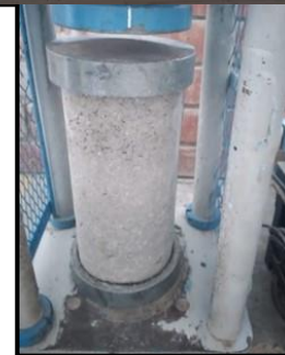
Anexo 4.4: Probetas cilíndricas F'c=50 \text{ kg/cm}^2 28 días. Fuente: Propia.
