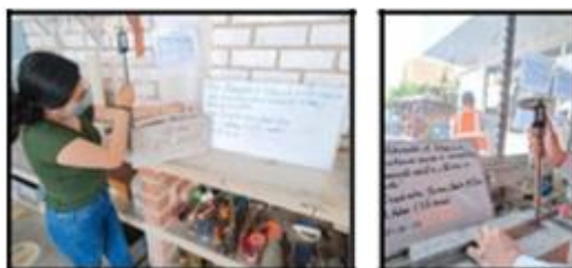
Figura N°56. Alabeo con el 5% de caucho
