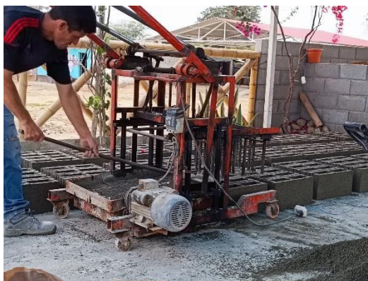
Figura N°30. Enrazando los bloques de concreto
