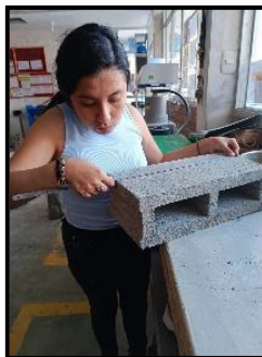
Figura N°61. V. dimensional del largo de bloque de concreto.
