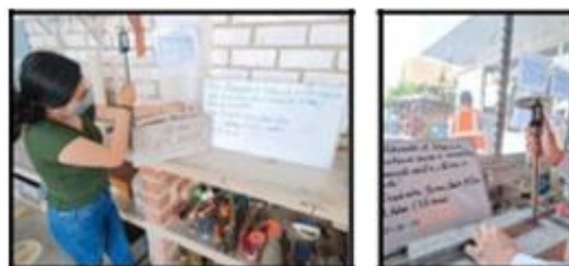
Figura N°57. Alabeo con el 15% de caucho
