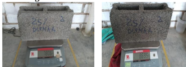
Figura N°54. Absorción con el 25% de caucho
