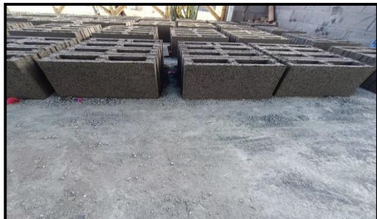
Figura N°32. Fraguado de los bloques de concreto
