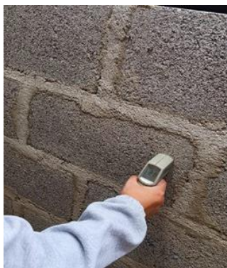
Figura N°115. Termómetro en la cara externa 25%
