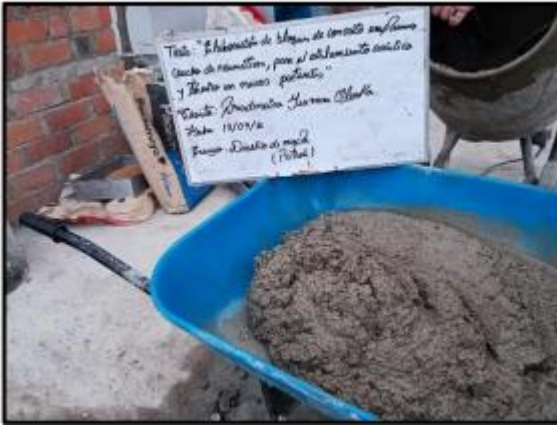
Anexo 2.1: Diseño de mezcla F'c=50 kg/cm 2 .
