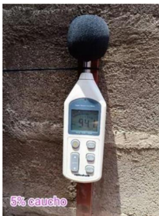
Figura N°87. Sonómetro en la cara interna 5% de caucho
