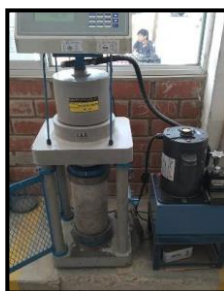
Figura N°24. Ensayo de resistencia a la compresión
