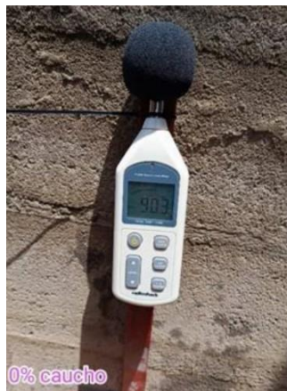
Figura N°86. Sonómetro en la cara interna 0% de caucho
