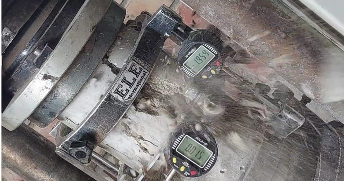
Imagen 43: Deformaciones - Ensayo de módulo de elasticidad y coeficiente de Poisson - Muestra 5% de HGM
