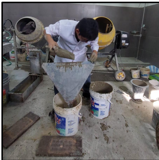
Ilustración 54: Proceso de llenado Embudo V
