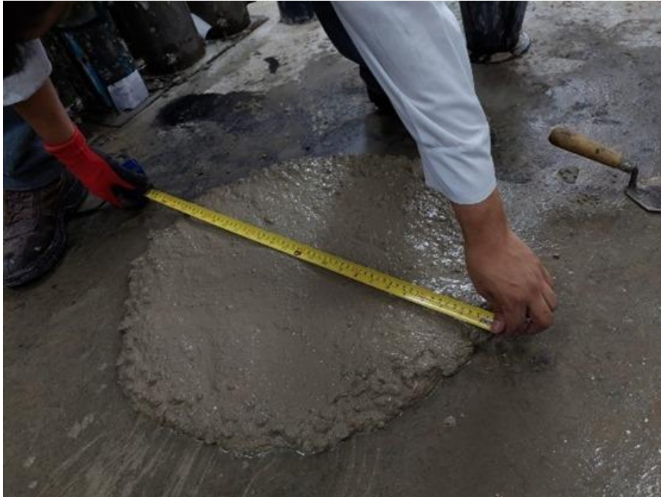
Imagen 21: Escurrimiento - muestra con 5% de HGM
