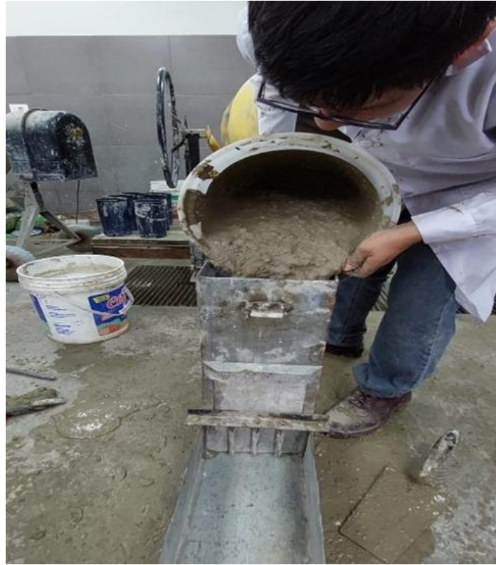
Imagen 23: Llenado de caja vertical - Ensayo de caja de paso L
