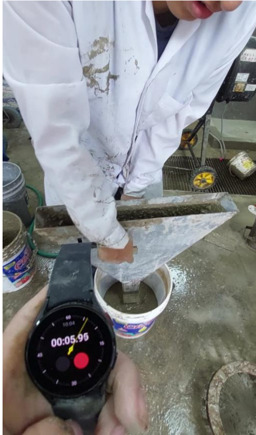
Imagen 31: Ensayo del embudo V - Muestra al 5% de HGM
