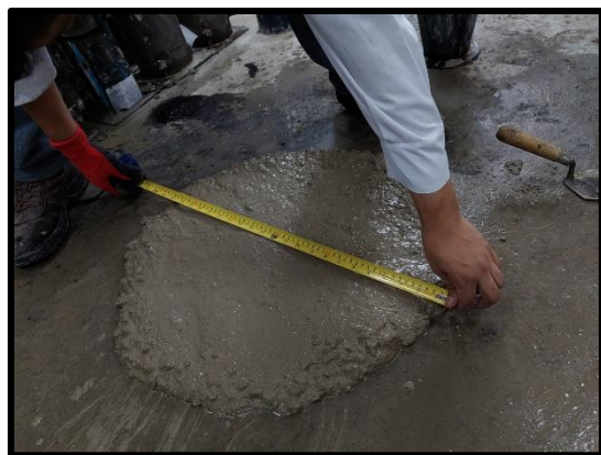
Ilustración 49: Slump de muestra al 5% de microesferas de vidrio
