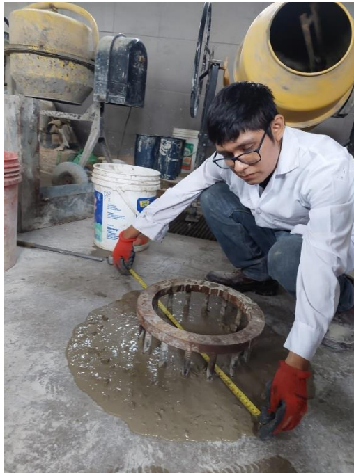
Imagen 35: Ensayo de Anillo J - Muestra con 5 de HGM
