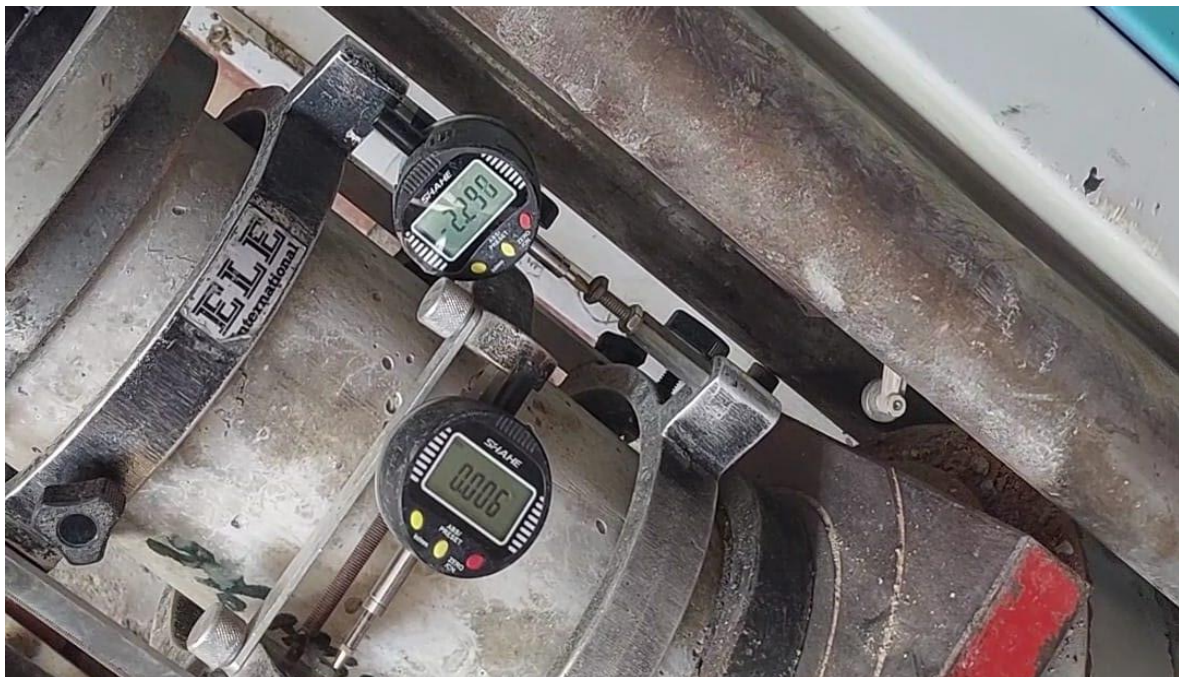
Imagen 44: Deformaciones - Ensayo de módulo de elasticidad y coeficiente de Poisson - Muestra 7% de HGM
