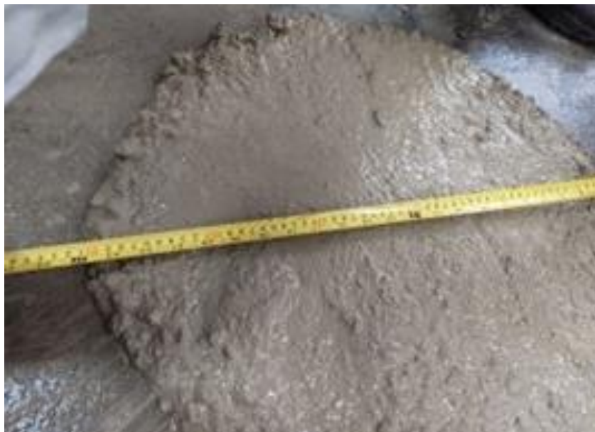
Imagen 22: Escurrimiento - Muestra con 7% de HGM
