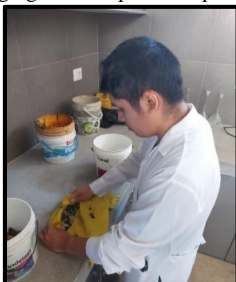
Ilustración 33: Secado superficial de la muestra
