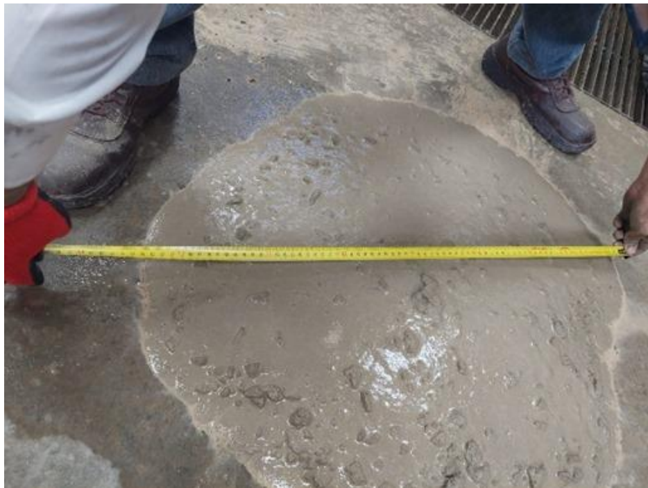
Imagen 20: Esgurrimiento muestra con 2% de HGM
