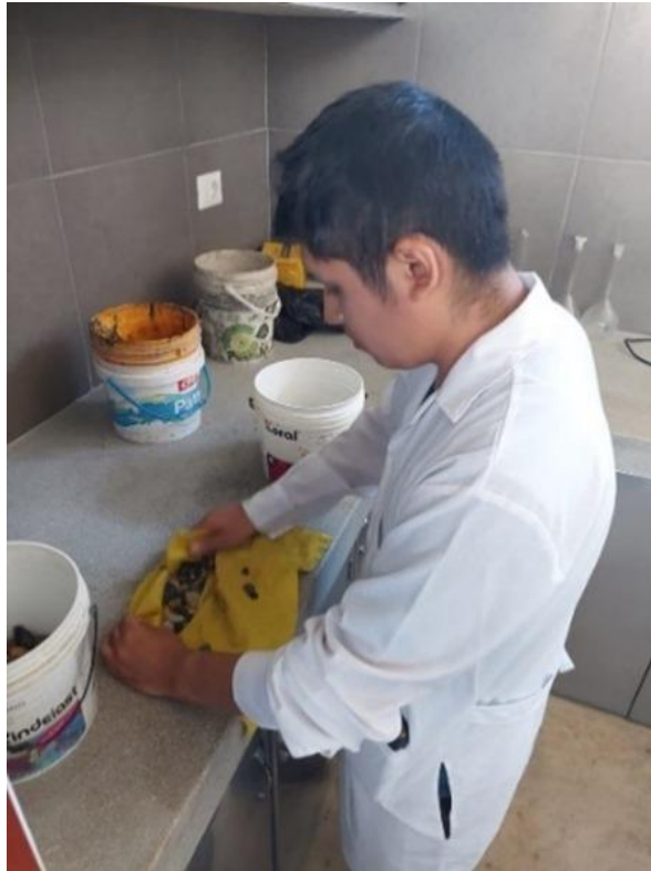
Imagen 9: Secado superficialmente de muestra de agregado grueso - ensayo para determinar el peso específico
