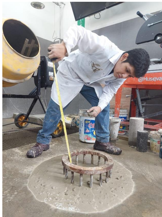
Imagen 36: Muestra con 2% de HGM - Ensayo del anillo J
