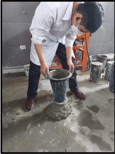
Ilustración 40: Escurrimiento de muestra de CAC – 2% aditivo
