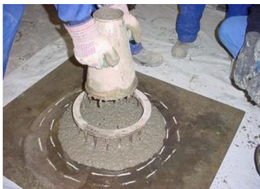
Ilustración 14: Ensayo Anillo J - M. Bravo Sobrino, Caracterización y utilización del hormigón autocompactable
