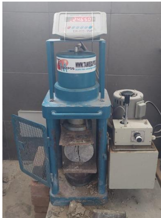
Imagen 40: Falla de muestra cilíndrica por Tracción indirecta
