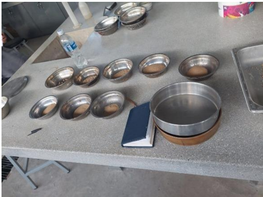
Imagen 2: Taras con muestras del ensayo de granulometría para el agregado fino
