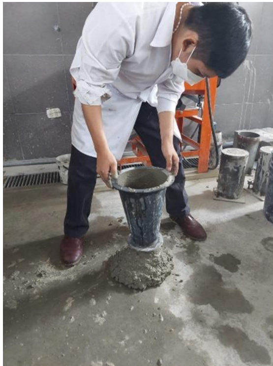
Imagen 13: Ensayo de asentamiento - Cono de Abrams
