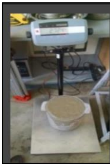
Ilustración 16: Peso unitario del concreto - Laboratorio N°3 - Universidad Ricaldo Palma
