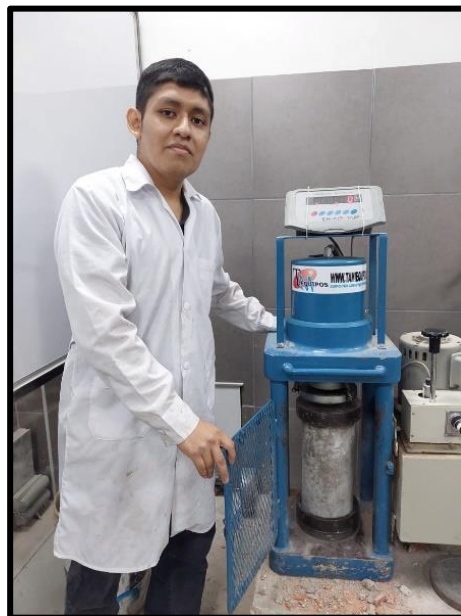
Ilustración 45: Verificación de resistencia a la compresión del diseño de mezcla
