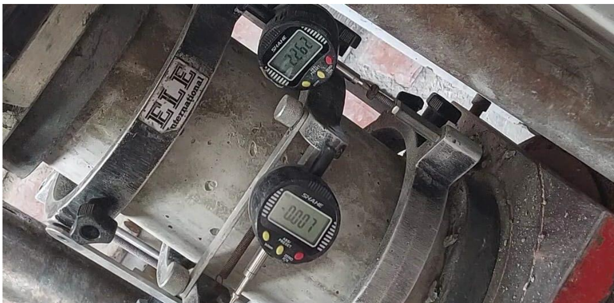
Imagen 42: Deformaciones - Ensayo de módulo de elasticidad y coeficiente de Poisson - Muestra 2% de HGM
