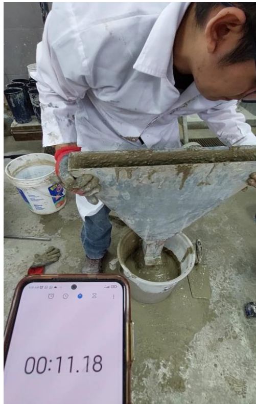
Imagen 29: Ensayo del embudo V apertura de compuerta - Muestra patrón
