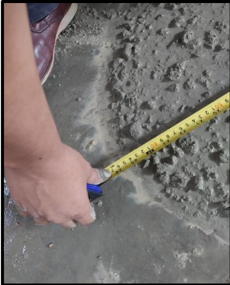
Ilustración 42: Slump 1 - Aditivo al 1.5%
