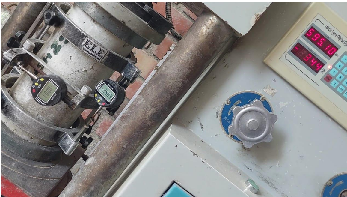
Imagen 41: Deformaciones - Ensayo de módulo de elasticidad y coeficiente de Poisson - Muestra Patrón
