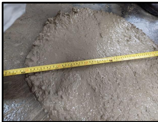
Ilustración 50: Slump al 7% de microesferas de vidrio
