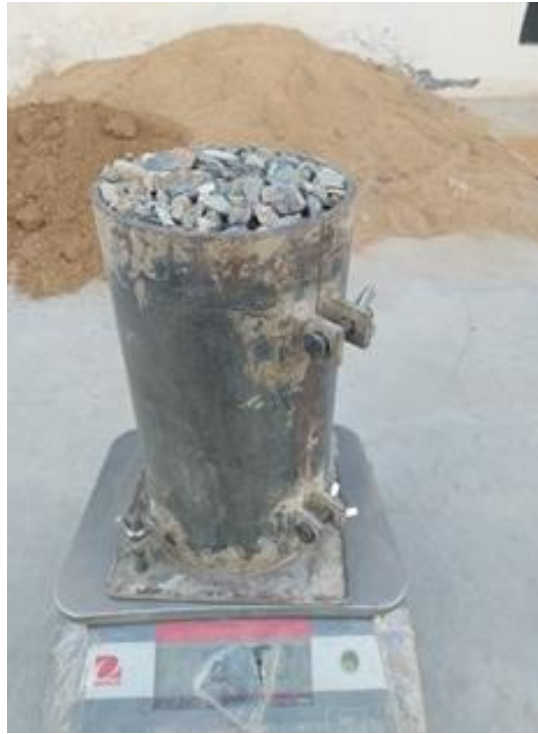
Imagen 3: Peso unitario compactado - agregado grueso
