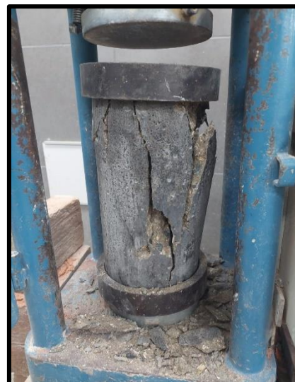
Ilustración 65: Falla de probeta
