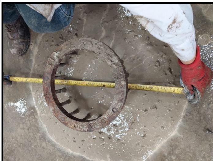
Ilustración 57: Medida del diámetro de flujo del CAC por el anillo J
