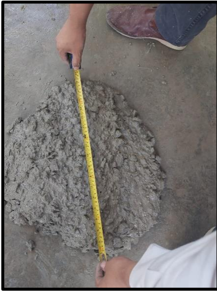
Ilustración 44: Slump 1 - Aditivo al 1%
