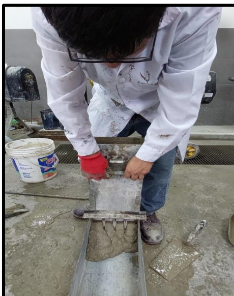
Ilustración 52: Proceso de abertura de la compuerta - Caja de paso L
