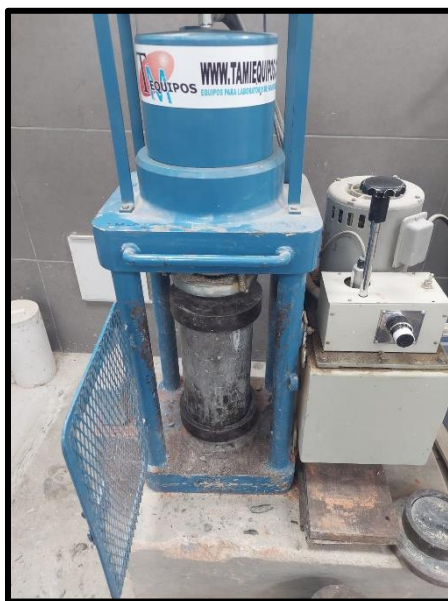
Ilustración 63: Ubicación de la probeta en la prensa hidráulica
