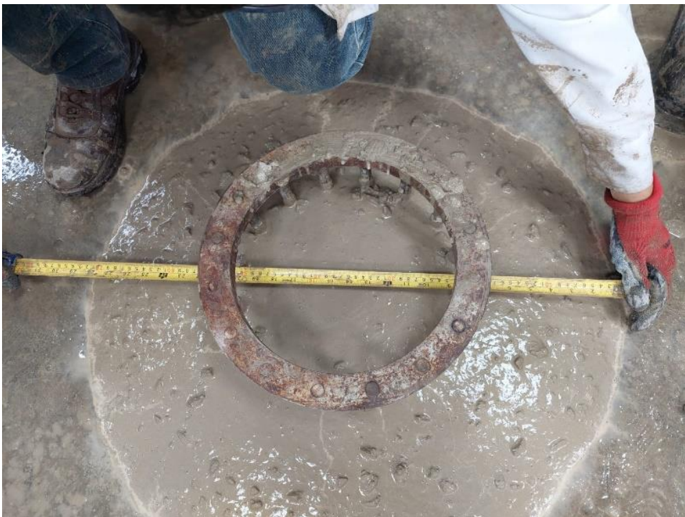
Imagen 34: Toma de medidas del diámetro de escurrimiento - Muestra con 7% de HGM
