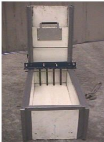
Ilustración 12: Caja L - M. Bravo Sobrino, Caracterización y utilización del hormigón autocompactable
