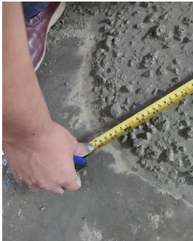
Imagen 15: Toma de medidas del diámetro de escurrimiento
