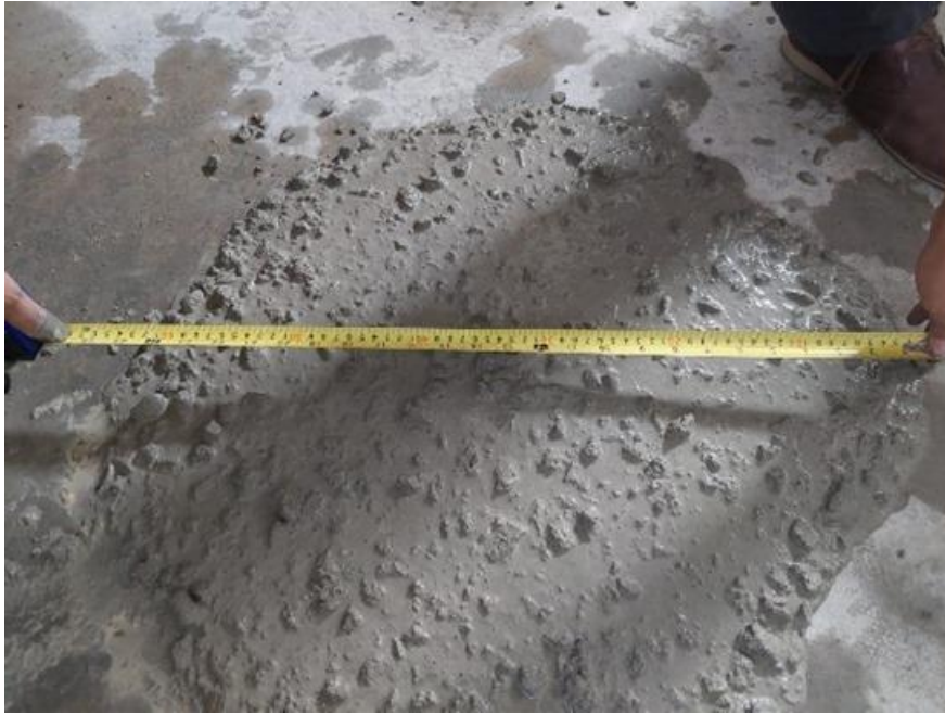
Imagen 16: Diámetro de escurrimiento - Slump
