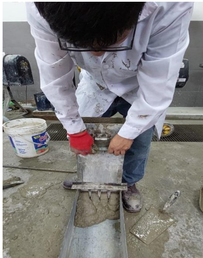
Imagen 24: Abertura de compuerta - Ensayo de caja de paso L
