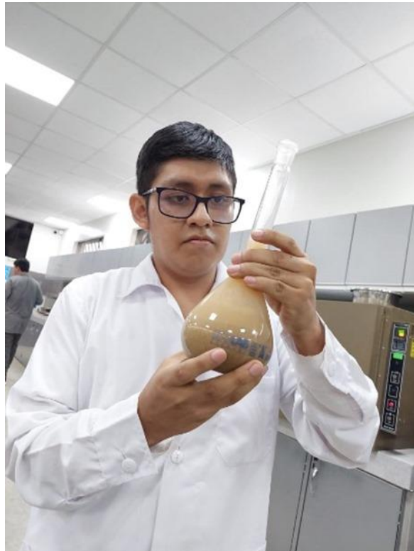
Imagen 8: Eliminación de aire atrapado - Fiola + Agua + muestra de arena
