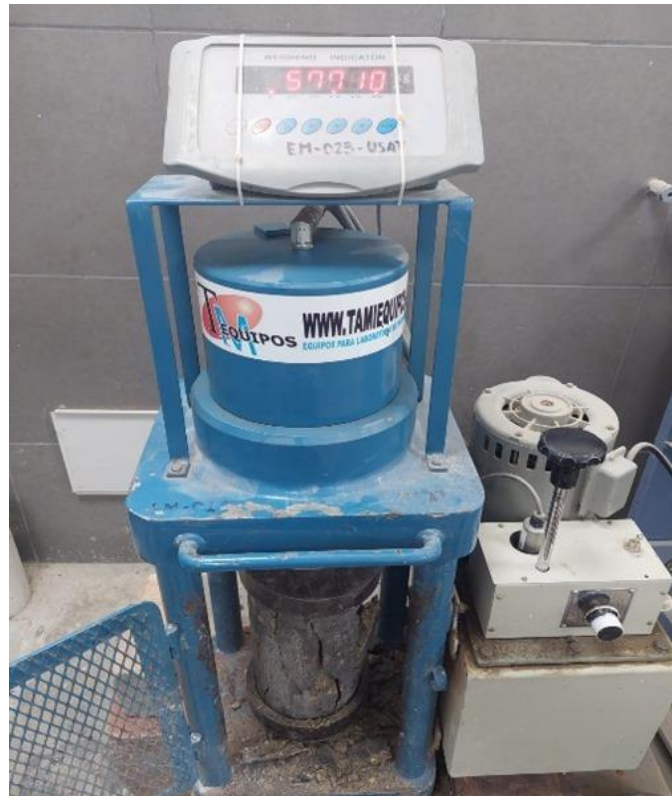
Imagen 37: Ensayo de resistencia a la compresión - Muestra de 7% de HGM
