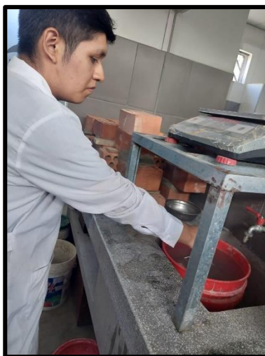
Ilustración 35: Muestra sumergida en la canastilla bajo agua
