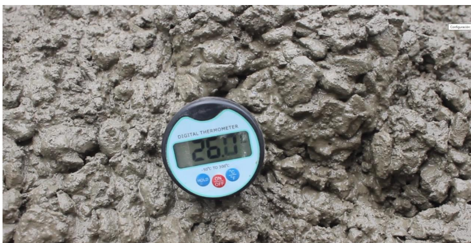
Ilustración 17: Temperatura del concreto en estado fresco – Ensayo practicado por Edgard Saldaña
