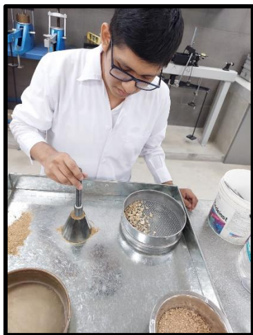
Ilustración 30: Apisonamiento de muestra en el cono
