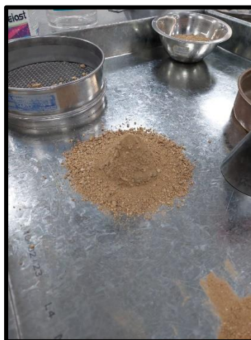
Ilustración 29: Comprobación de la muestra superficialmente seca
