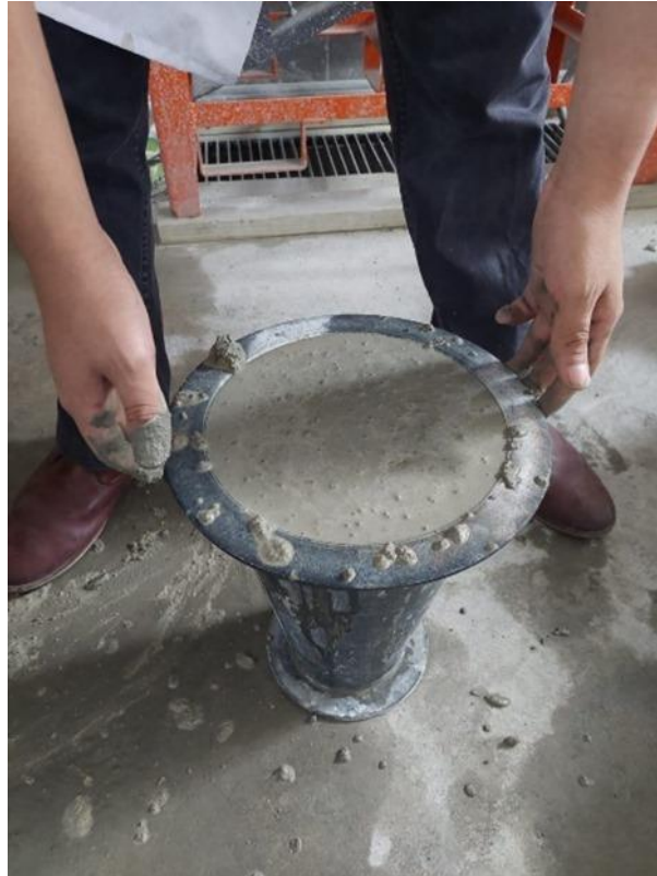
Imagen 14: Ejecución del ensayo del cono de Abrams
