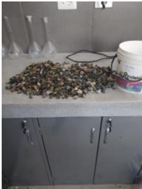
Imagen 10: Muestra de agregado grueso superficialmente seca
