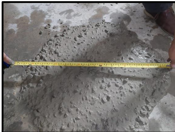
Ilustración 47: Slump de muestra patrón
