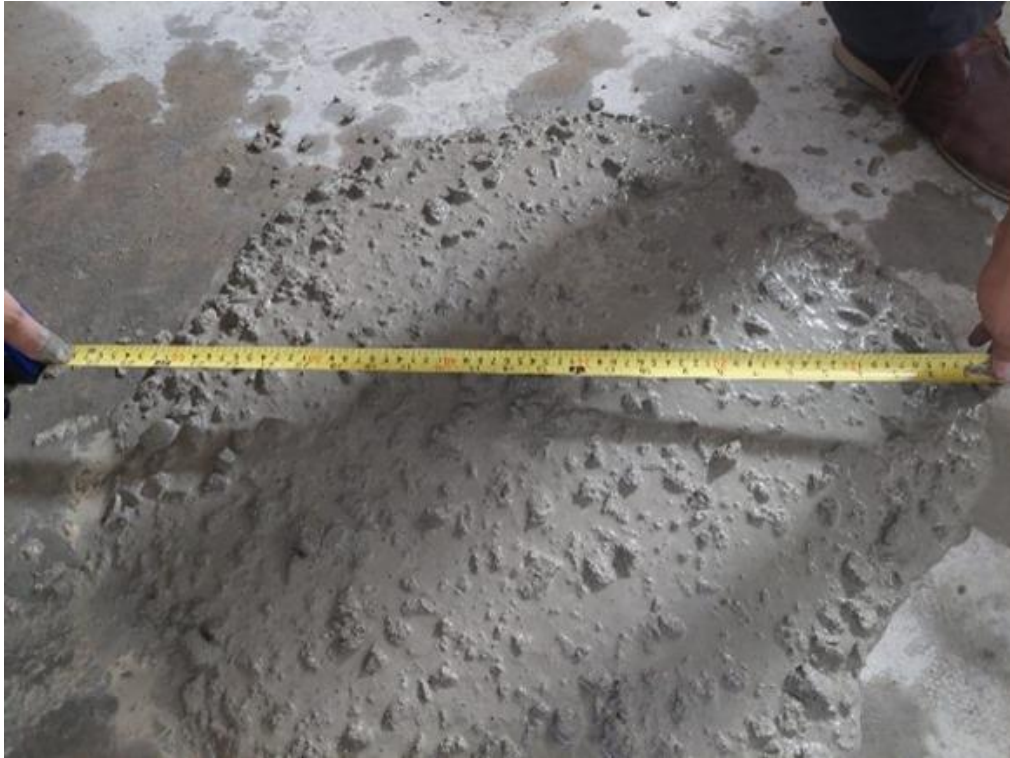
Imagen 19: Esgurrimiento - Muestra Patrón
