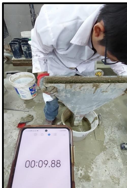
Ilustración 55: Registro de tiempo de paso por el Embudo V
