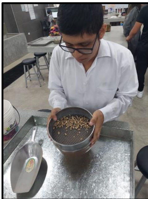
Ilustración 28: Tamizado de muestra de agregado fino - Malla N°4
