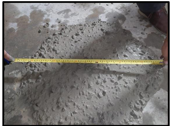
Ilustración 41: Slump 2 - Aditivo al 1.5%
