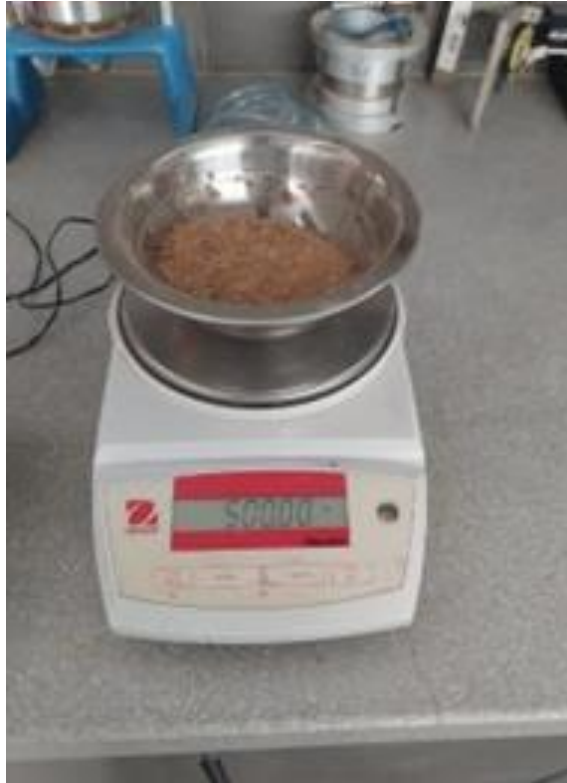
Imagen 12: Peso de muestra de agregado fino - ensayo de % de humedad
