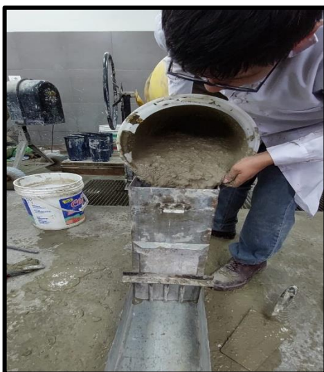
Ilustración 51: Proceso de llenado de la caja vertical- Caja de paso L
