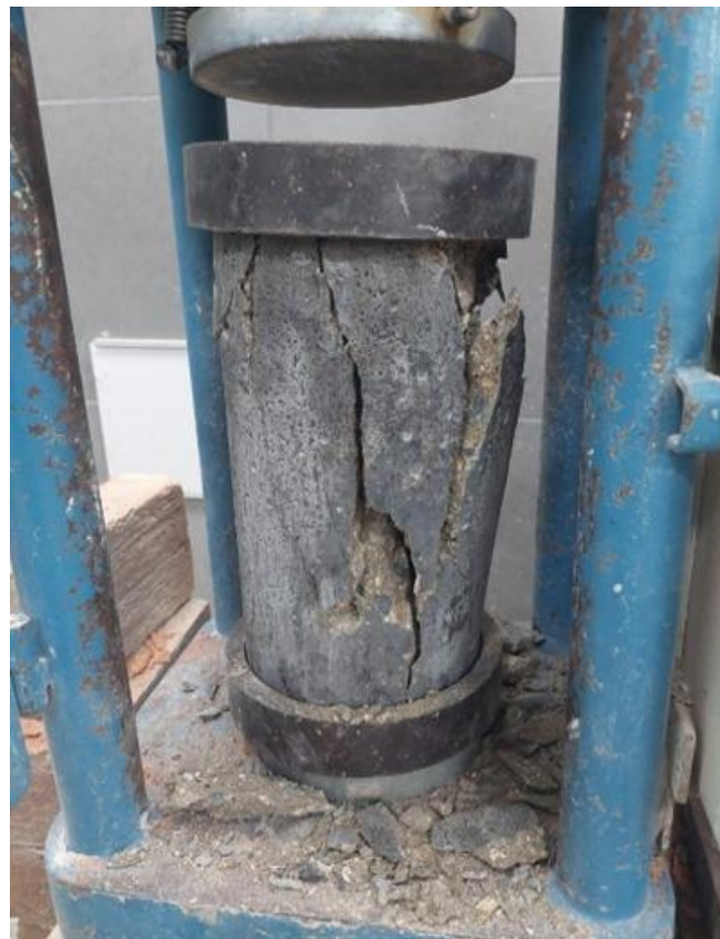
Imagen 38: Falla de probeta cilíndrica - Muestra al 7% de HGM
