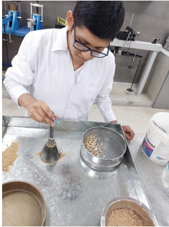
Imagen 7: Prueba que determina visualmente la humedad del agregado fino
