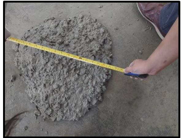
Ilustración 43: Slump 2 - Aditivo al 1%
