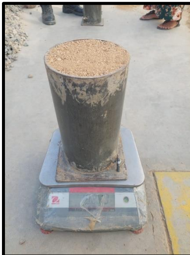
Ilustración 26: Peso compactado de muestra de agregado fino
