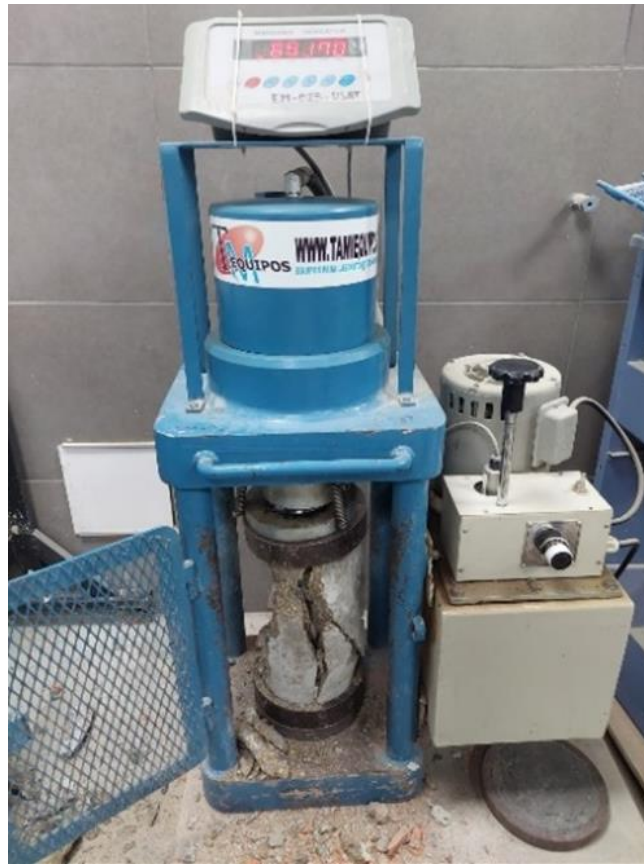
Imagen 18: Ruptura y registro de resistencia a la compresión - Muestra Patrón 28 días de curado
