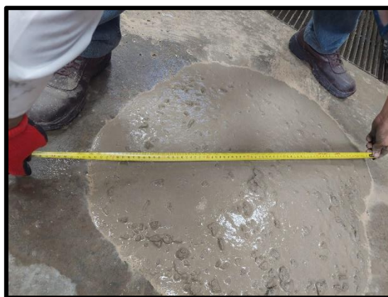
Ilustración 48: Slump de muestra al 2% de microesferas de vidrio
