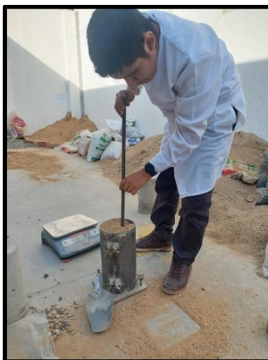
Ilustración 27: Varillado de muestra de agregado fino
