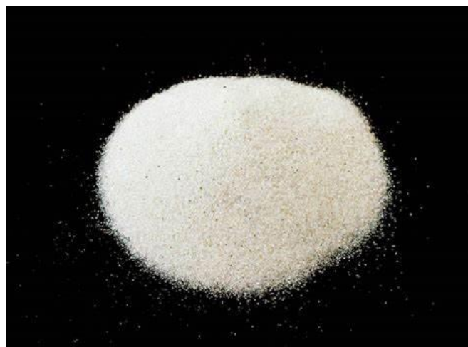
Ilustración 22: Foto de Microesferas de Vidrio Ballotini M247 - Tipo I
