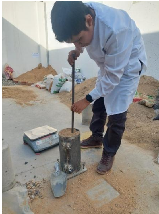
Imagen 5: Proceso de compactación del agregado fino
