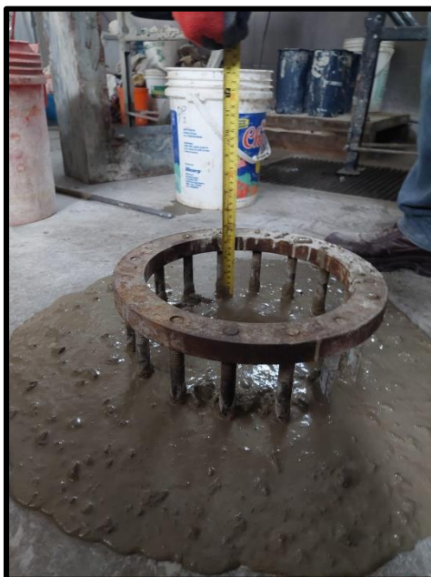
Ilustración 58: Medidas de H1 de muestra retenida por el anillo J
