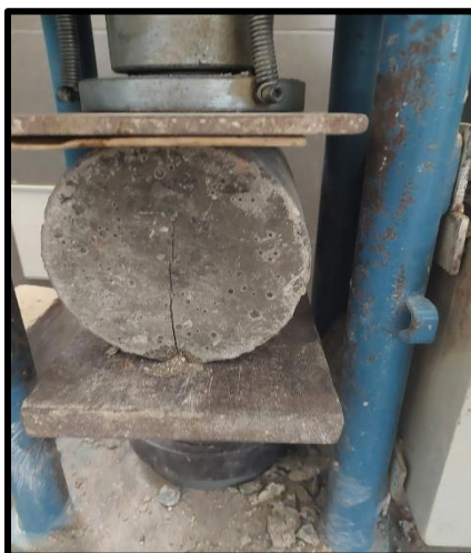
Ilustración 66: Ubicación de probeta en la prensa hidráulica para ensayo de tracción indirecta
