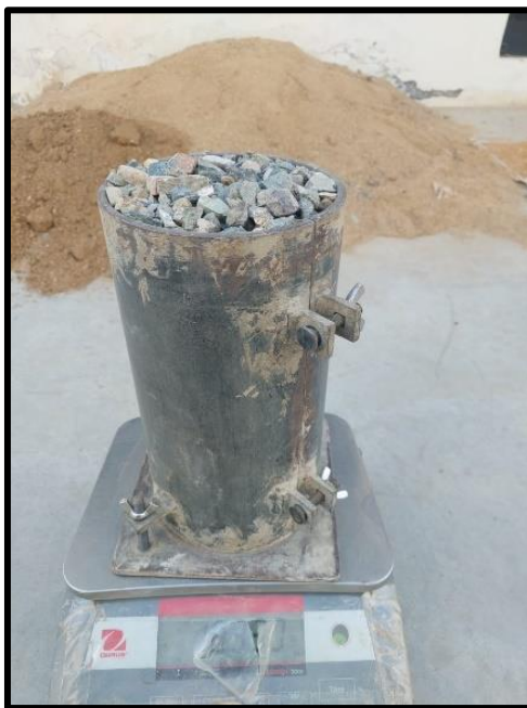
Ilustración 25: Peso compactado de muestra de agregado grueso
