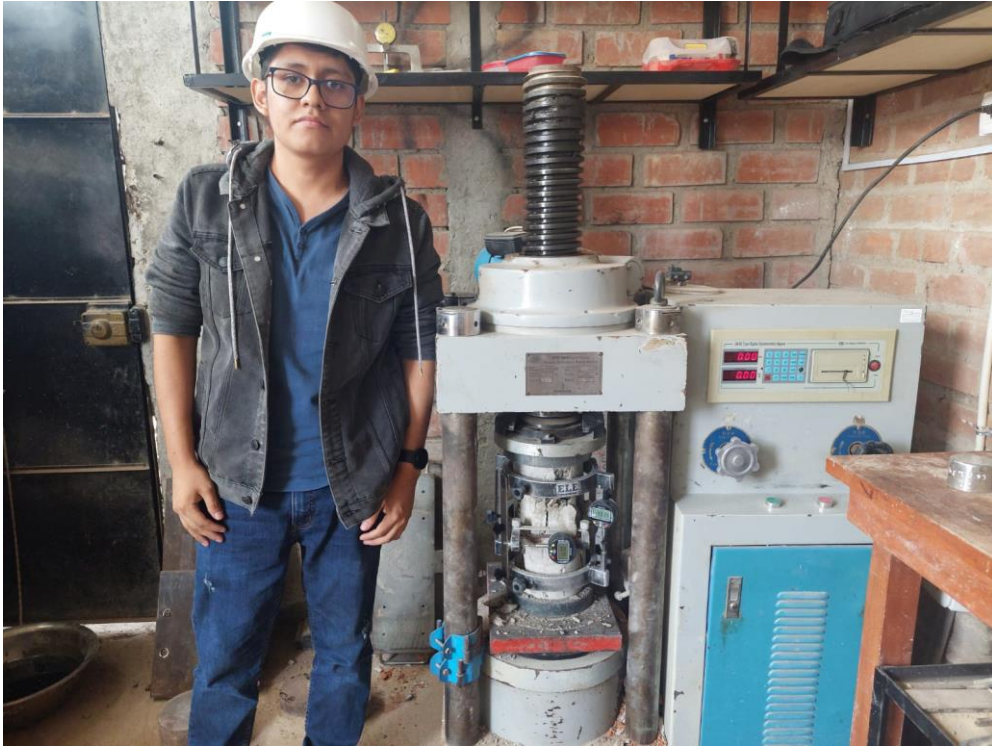
Imagen 45: Ejecución del ensayo del Módulo de elasticidad y coeficiente de Poisson
