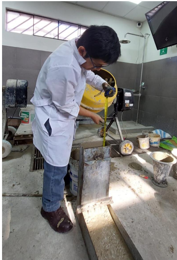
Imagen 27: Toma de medida H2, Caja vertical - Ensayo de caja de paso L
