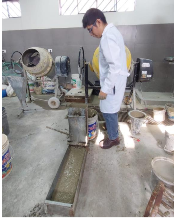
Imagen 28: Ejecución del ensayo de caja de Paso L
