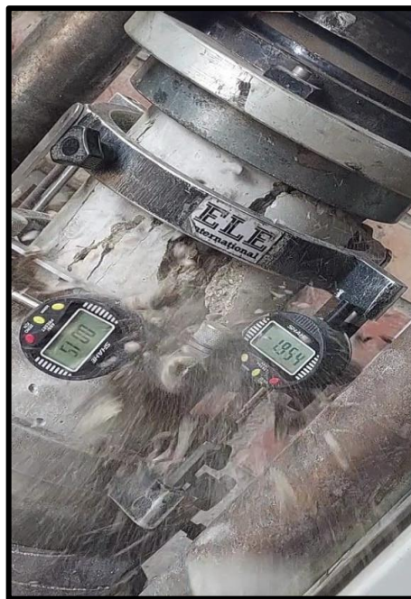
Ilustración 68: Deformaciones al momento de falla de la muestra de concreto
