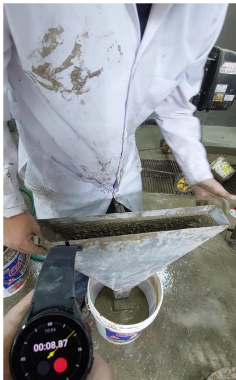
Imagen 32: Ensayo del embudo V - Muestra al 7% de HGM
