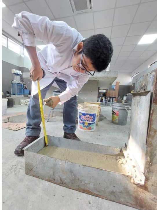
Imagen 25: Toma de altura H1 - Caja horizontal - Ensayo de Caja de paso L
