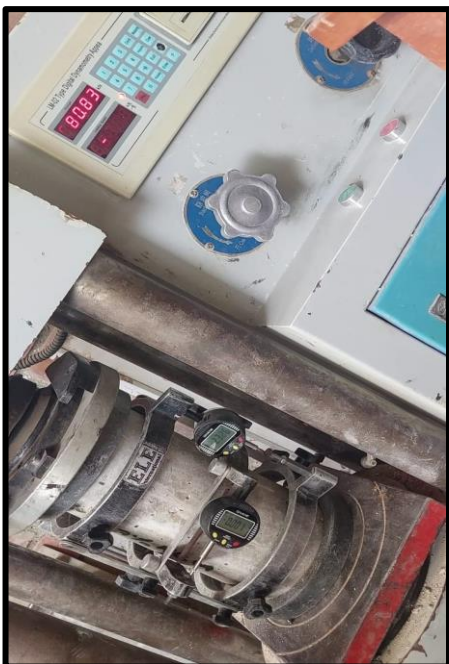
Ilustración 69: Lectura de deformaciones longitudinales y diametrales
