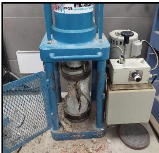
Ilustración 46: Ruptura de la muestra piloto
