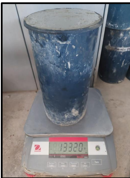
Ilustración 60: Peso de muestra de CAC + molde
