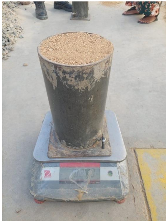
Imagen 4: Peso unitario compactado - Agregado fino
