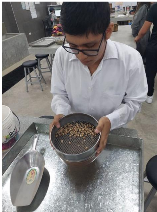
Imagen 6: Tamizado por la malla N°4 - Ensayo de peso específico del agregado fino
