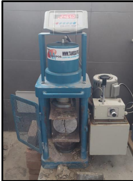
Ilustración 67: Falla por tracción indirecta de probeta cilíndrica
