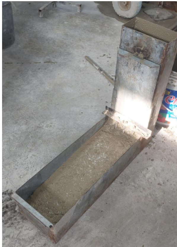
Imagen 26: Reposo de muestra de CAC en la caja de paso L
