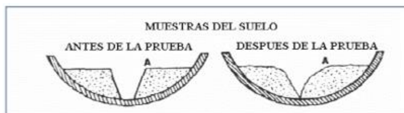
Ilustración 15. Antes y después de los golpes de la muestra de suelo acanalada
